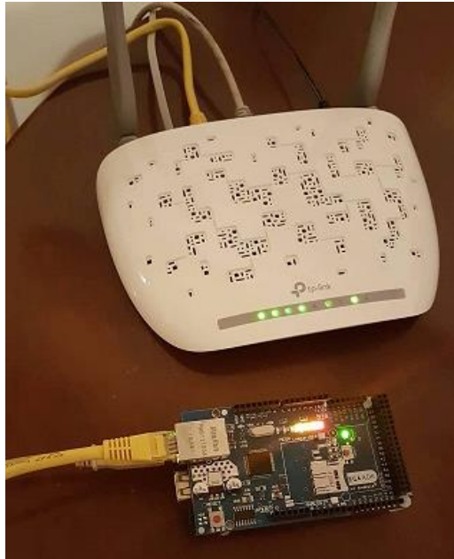
Εικόνα 42: Σύνδεση Ethernet shield με arduino
