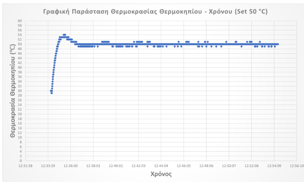
Εικόνα 107. Γραφική παράσταση θερμοκρασίας θερμοκηπίου – Χρόνου (Set 50 °C)
