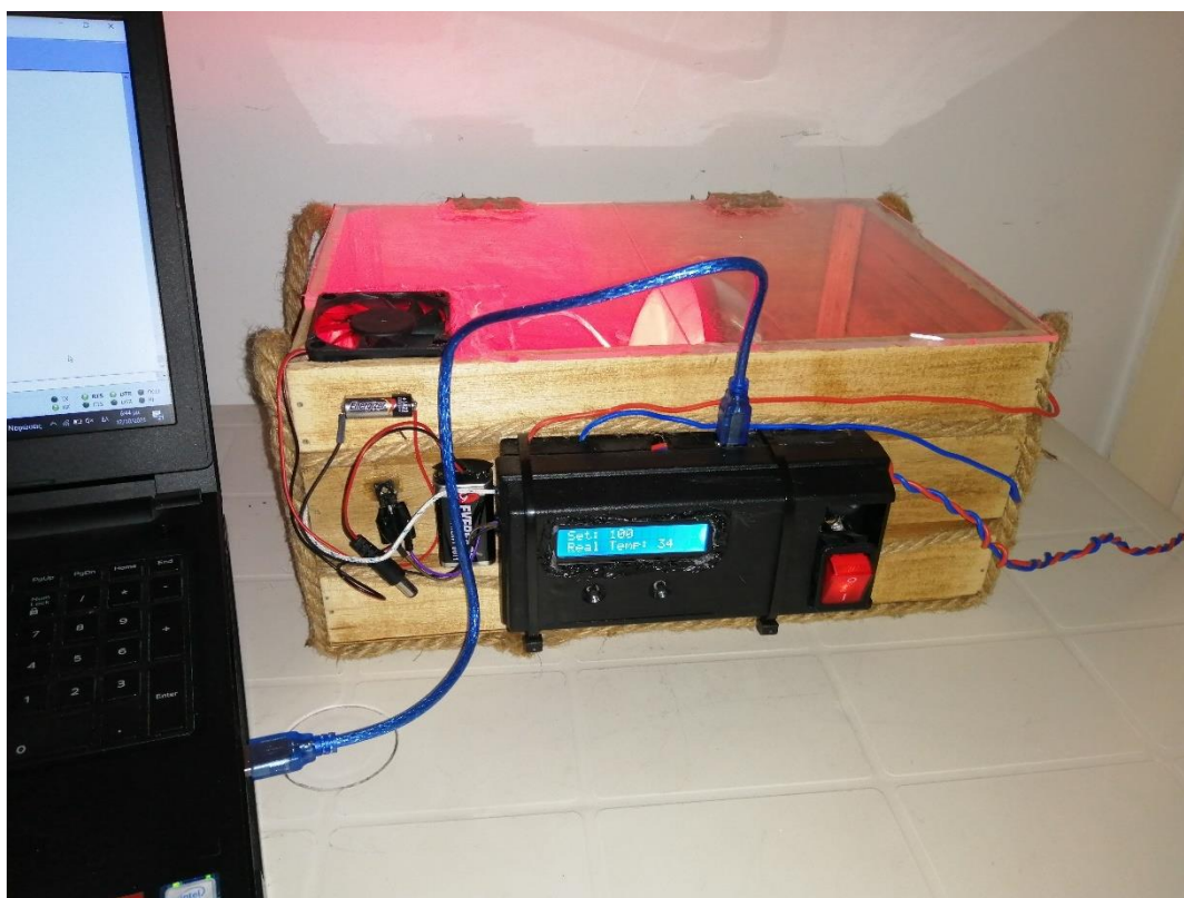
Εικόνα 100. Μονάδα ελέγχου περιβάλλοντος θερμοκηπίου
