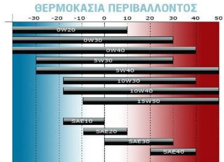
Εικόνα 8. Εύρος χρήσης των τυποποιημένων λιπαντικών SAE σε σχέση με την θερμοκρασία περιβάλλοντος [1.8]
