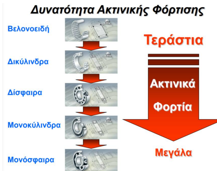
Εικόνα 4. Τα είδη των ρουλεμάν κατά σειρά δυνατότητας υποστήριξης ακτινικών φορτίων [1.4]
