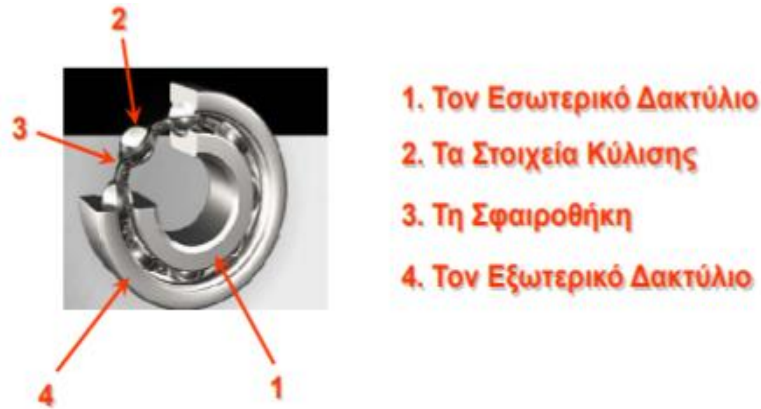
Εικόνα 3. Τα μέρη που αποτελείται ένα ρουλεμάν [1.3]
