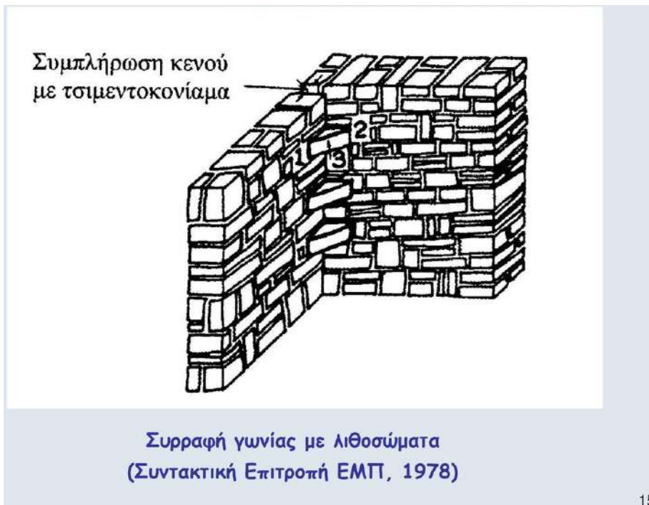
Σχήμα 2.12 Συρραφή γωνίας με λιθοσώματα (ΕΜΠ 1978)
