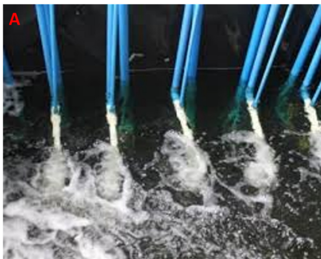
Εικόνα 2.6: A) Εγχυτήρες Venturi, B) Κώνος Speece. (Πηγή: purehydroponics.com )
