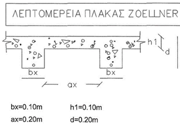
Εικόνα 12. Τομή δοκιδοτής πλάκας ή πλάκας Zoellner. (Πηγή: Χ. Ζέρης – Σημειώσεις Ιαν. 2014)
