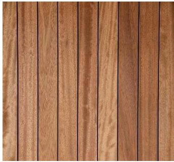
Εικόνα 69. Προτεινόμενο δάπεδο εξωτερικού χώρου Ιρόκο
