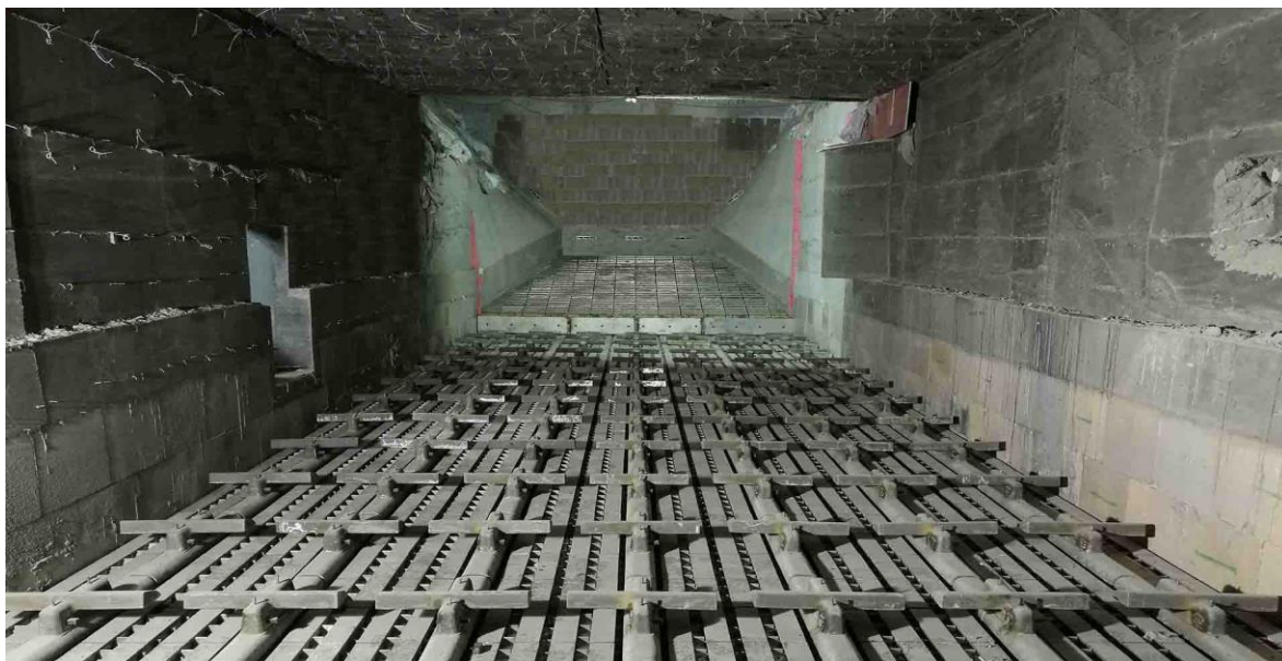
Εικόνα 23: Cross-bar cooler από την εταιρία FLSmidth [44].
