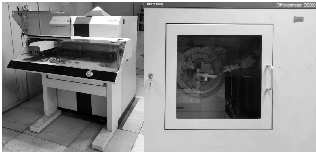
Εικόνα 39: Ακτινοδιαγνωστικές μέθοδοι. Αριστερά ανάλυση με την μέθοδο XRF από την εταιρία THERMO και δεξιά ανάλυση με την μέθοδο XRD από την εταιρία SIEMENS. (Τιτάν, Εργοστάσιο Δρεπάνου) [8]
