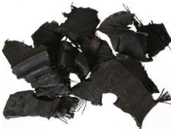
Εικόνα 72: Τεμαχισμένα ελαστικά με μέγεθος 5cm·5cm κατάλληλα για καύση σε κλιβάνους τσιμέντου από την εταιρία UNIREC [61].
