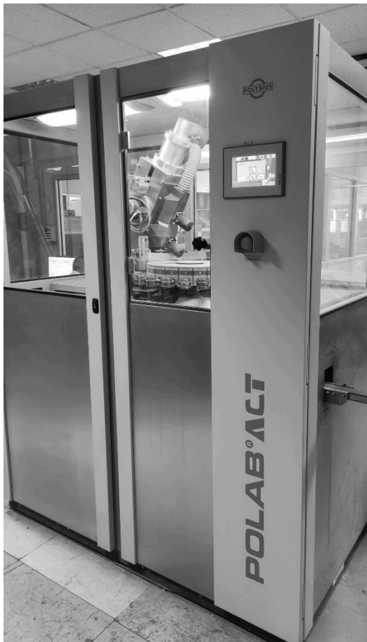
Εικόνα 38: Πλήρως αυτοματοποιημένος δειγματολήπτης από την εταιρία POLYSIUS . (Τιτάν, Εργοστάσιο Δρεπάνου) [8]
