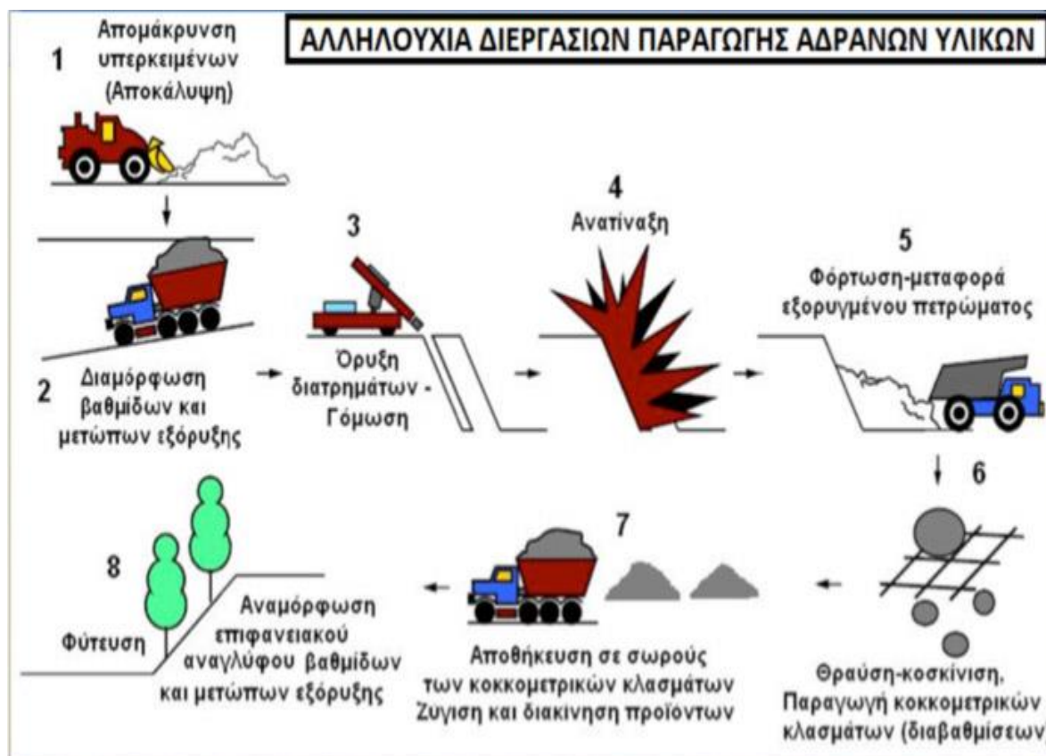
Εικόνα 4: Σχηματική αναπαράσταση των απαραίτητων εργασιών σε ένα λατομείο αδρανών υλικών. [31]
