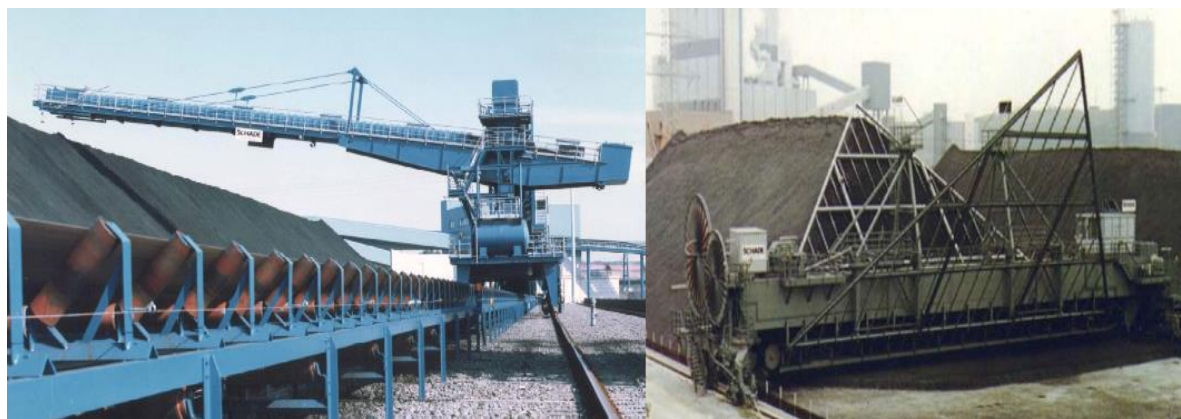
Εικόνα 9: Αποθέτης και παραλήπτης αδρανών υλικών [36]
