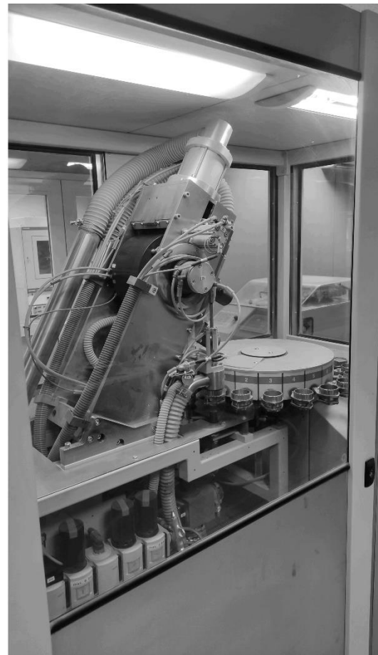
Εικόνα 38: Πλήρως αυτοματοποιημένος δειγματολήπτης από την εταιρία POLYSIUS . (Τιτάν, Εργοστάσιο Δρεπάνου) [8]
