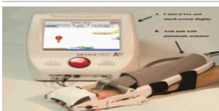
Εικόνα 8.3: Η ρομποτική συσκευή Hand Mentor Pro και τα επιπλέον εξαρτήματα της (researchgate.net)
