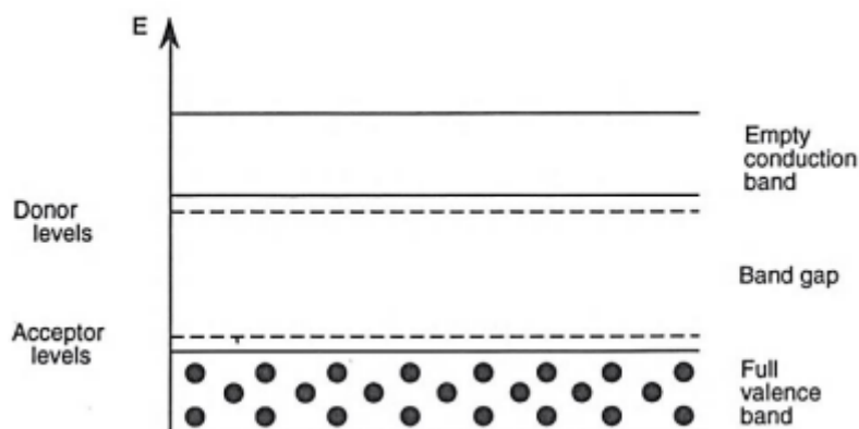
Σχήμα 1.9 Σχηματικό διάγραμμα δομής ζωνών σε έναν ημιαγωγό προσμείξεων.
