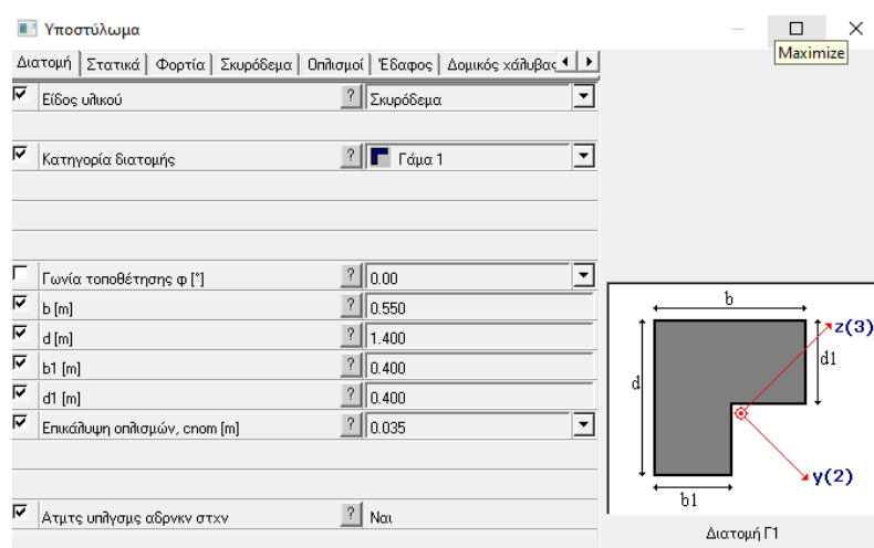
Εικόνα 77 Παράμετροι διατομής ενισχυόμενου υποστυλώματος. Λογισμικό FespaC & FespaR έκδοση 8.1.0.22
