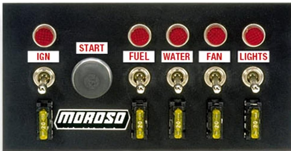
Εικόνα 2.9 : Ηλεκτρονικός πίνακας ελέγχου οχήματος Buggy
