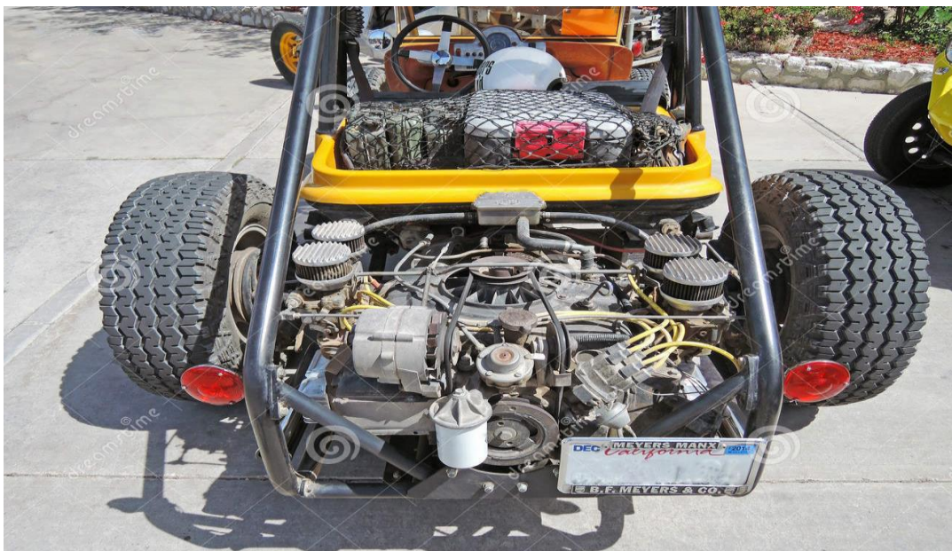
Εικόνα 2.4 : Buggy με κινητήρα συμβατικού αυτοκινήτου
