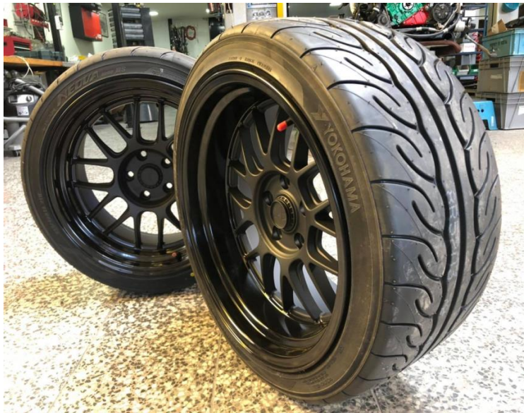
Εικόνα 2.7 : Ελαστικό και ζάντες αγωνιστικής ασφάλτου χρήσης Yokohama
