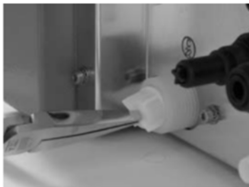
Εικόνα 5.7.8.: Διαδικασία αφαίρεσης φίλτρου.
