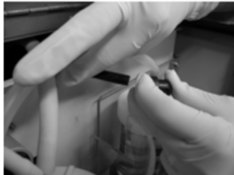
Εικόνα 7.7.8.: Αφαίρεση μαύρων σωλήνων εισόδου και εξόδου από τον συμπυκνωτή.
