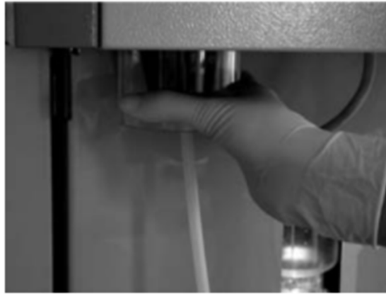
Εικόνα 6.7.8.: Αφαίρεση προστατευτικού και ένωσης σωλήνων.
