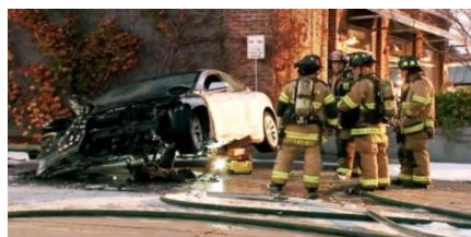
Σχήμα 2.3 : Tesla model S πιάνει δεύτερη φωτιά, αφού έχει προηγηθεί η πρώτη κατάσβεση της, λόγω λανθάνον ενέργεια [42]
