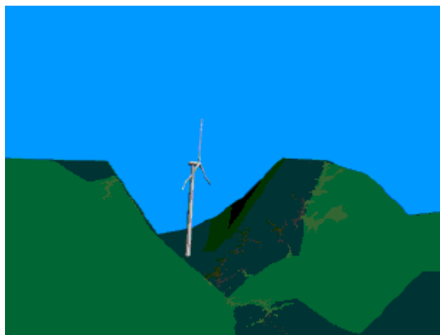
Εικόνα 5-4 Τοποθέτηση Α/Γ ανάμεσα σε δύο λόφους με σκοπό την εκμετάλλευση της αύξησης της ενέργειας του ανέμου
