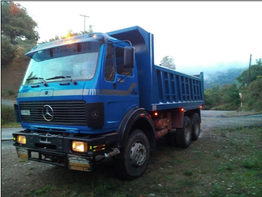
Εικόνα 3.18: Mercedestριαξονικό 2638 μεικό φορτίο 26000kg 380 hp 12m 3 καρότσα κατανάλωση 1.2 l/km
