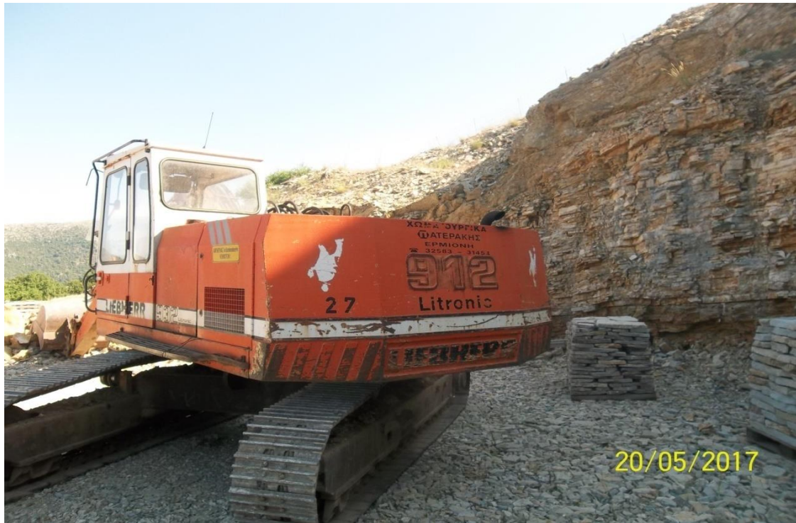
Εικόνα 3.15: Εκσκαφέας LIEBHERR 912LC ερπυστριοφόρος 1988 19500kg 2,3km/h 70 kw
