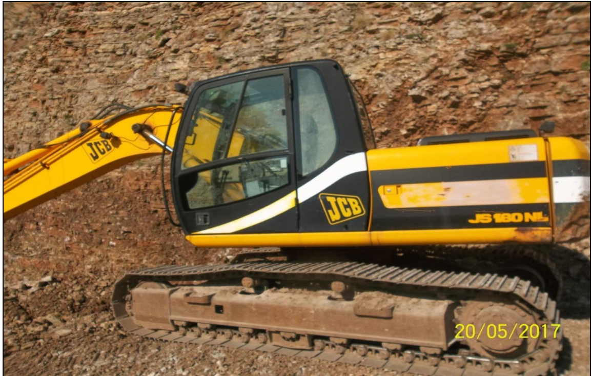
Εικόνα 3.16: Εκσκαφέας JCB JS180 NL TURBO ερπυστριοφόρος 2001 17000kg 4km/h 70 kw κατανάλωση 10.1 l/h 1/3 m 3
