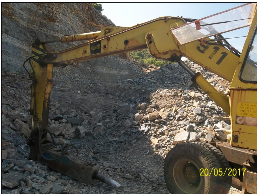
Εικόνα 3.14: Εκσκαφέας LIEBHERR 911C λαστιχοφόρος 1981 17600kg 20km/h 65 kw
