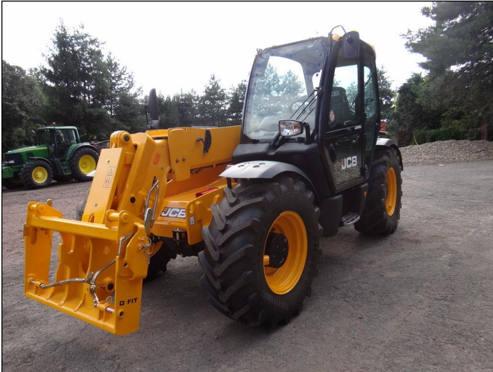
Εικόνα 3.17: Τηλεσκοπικό Κλαρκ JCB 531 TURBO ύψος ανύψωσης 7m βάρος ανύψωσης 3100kg 2002 7500kg 35km/h 55kw κατανάλωση 7.5 l/h
