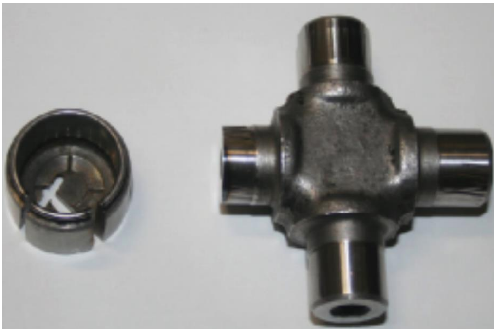
Εικόνα 2.10: Δείγμα αποτυχημένης άρθρωσης Cardan [18]
