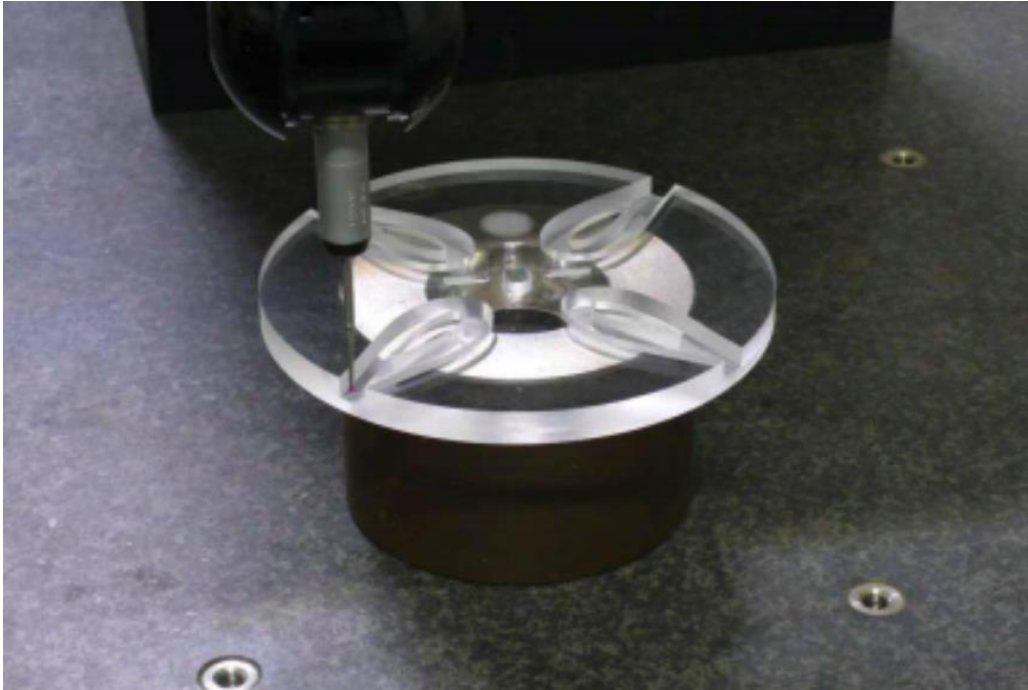
Εικόνα 1.15: Μέτρηση των εγκοπών μηχανής σε μια μηχανή μέτρησης συντεταγμένων τριών αξόνων [5]
