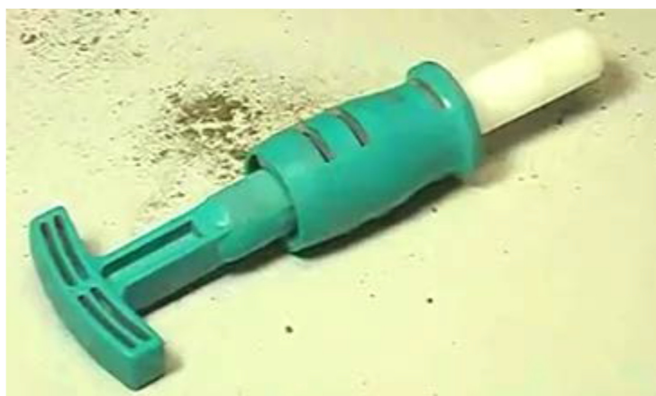
Εικόνα 38 Δειγματολήπτης ESS Core N' One 25g της Environmental Sampling Supply9. Ογκομετρικός δειγματολήπτης εδάφους που διατίθεται στο εμπόριο (παρουσιάζεται στο video που δείχνει την διαδικασία βαθμονόμησης (Decagon, 2017β))
