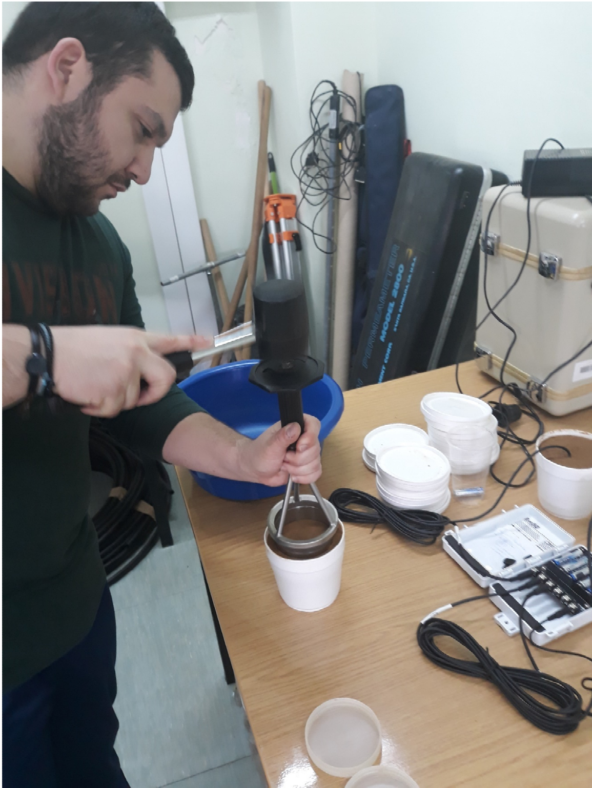
Εικόνα 54 Προσεκτική τοποθέτηση κυλίνδρου στο δείγμα
