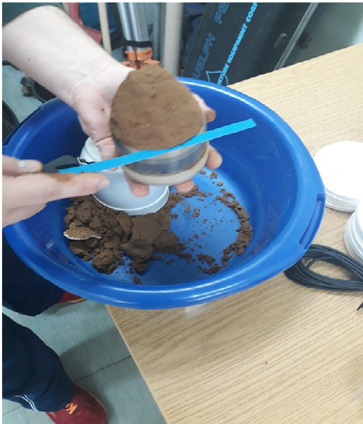
Εικόνα 57 Καθαρισμός επιπέδων εδάφους
