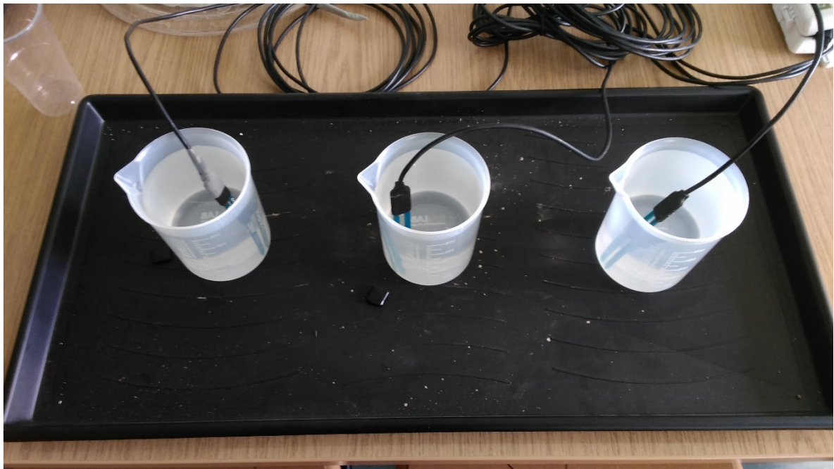
Εικόνα 46 Δοκιμή αισθητήρων EC-5 στο νερό
