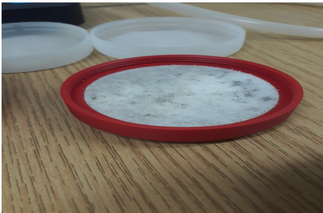
Εικόνα 51 Πορώδες καπάκι που χρησιμοποιήθηκε στον κύλινδρο αδιατάρακτου δείγματος για την εύρεση του κορεσμού
