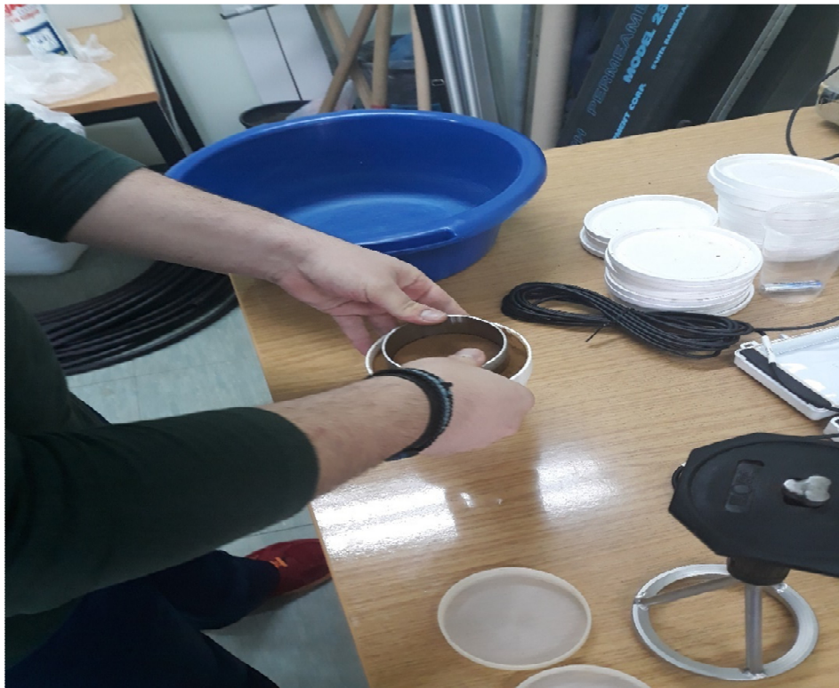
Εικόνα 53 Τοποθέτηση κυλίνδρου για τη συλλογή αδιατάρακτου δείγματος.
