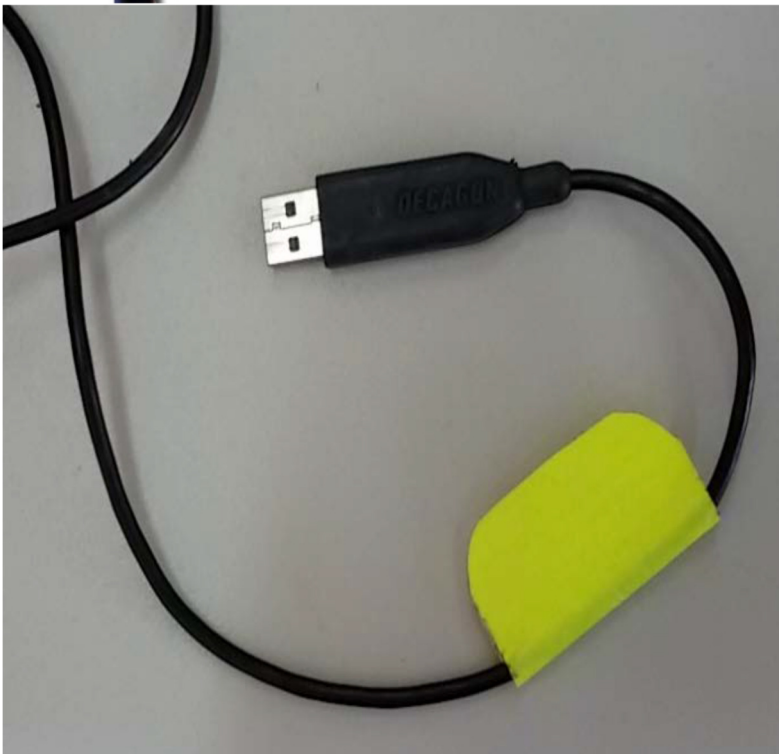
Εικόνα 21 Σήμανση καλωδίου αισθητήρα (Bissey, 2012) και σήμανση καλωδίου σύνδεσης καταγραφικού με Η/Υ (Τσιρογιάννης, 2017)
