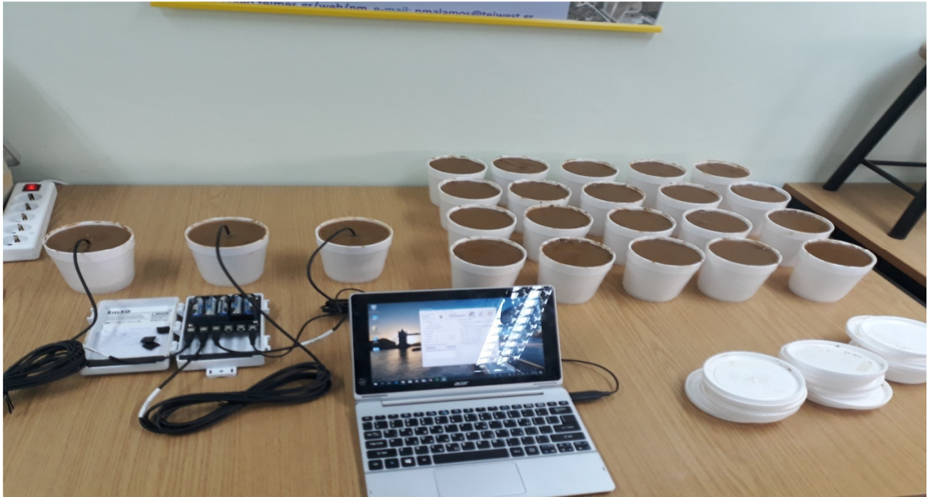
Εικόνα 52 Καλιμπράρισμα αισθητήρων και αρχή πειράματος
