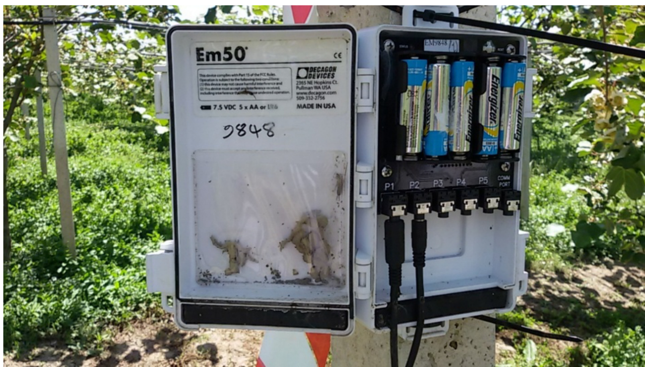
Εικόνα 22 Το καταγραφικό Decagon em50 στον αγρό. Στο περιβάλλον του αγρού δεν είναι σπάνιο να βρίσκονται έντομα και κατασκευές τους μέσα στο κουτί του καταγραφικού.
