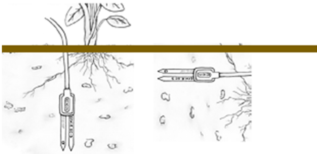
Εικόνα 16 Προτεινόμενος προσανατολισμός επιπέδου αισθητήρα ως προς επίπεδο εδάφους ώστε να ελαχιστοποιούνται οι επιδράσεις από την προς τα κάτω κίνηση του νερού (Decagon, 2012)
