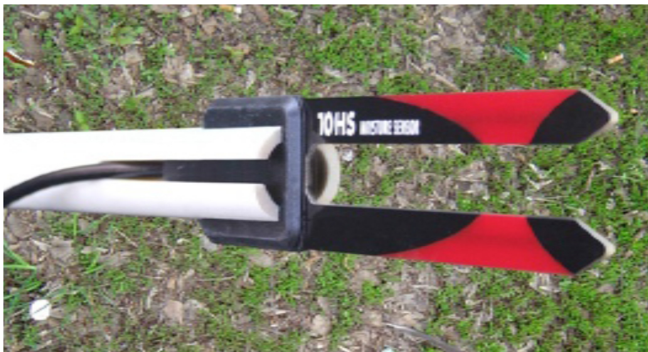
Εικόνα 18 Σωλήνας PVC ειδικά διαμορφωμένος ως εργαλείο τοποθέτησης αισθητήρα (πηγή: Onset – Installing Soil Moisture Sensors)
