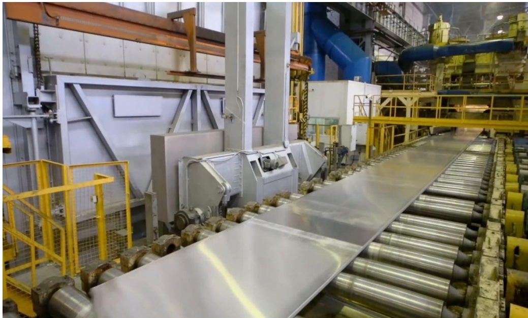
Εικόνα 2.4: Φωτογραφία διαδικασίας έλασης πλάκας
