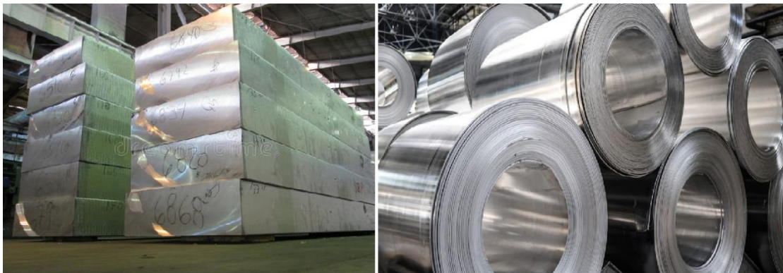
Εικόνα 2.2: Τελικό προϊόν διαδικασίας έλασης
