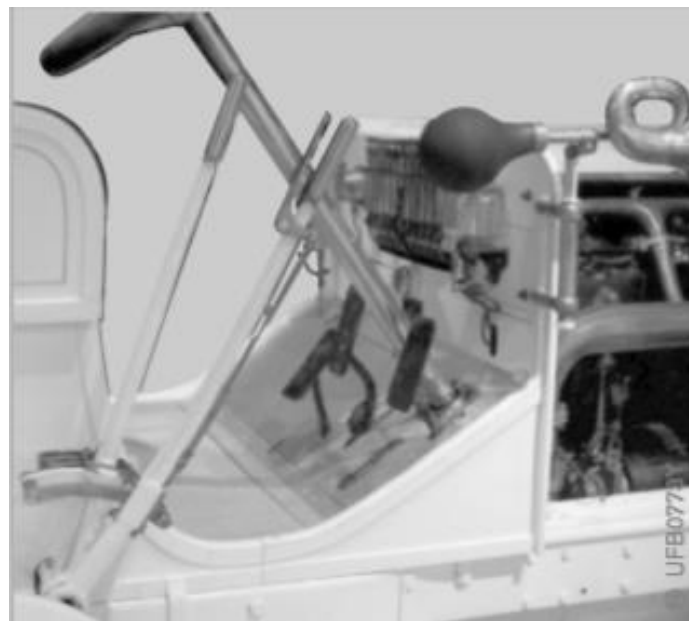
Εικόνα 1.2 Μηχανισμός πεντάλ και μοχλού στη θέση του οδηγού της Mercedes Simplex του 1902 [9].
