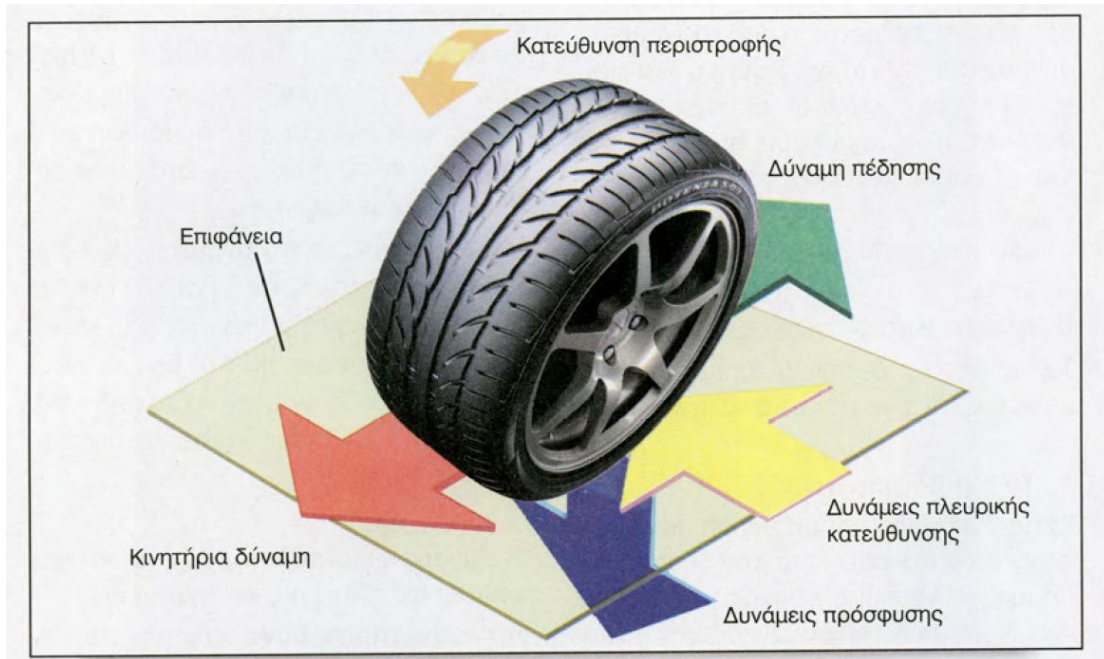
Σχήμα 1.1 Οι δυνάμεις που ασκούνται στους τροχούς του αυτοκινήτου [3].
