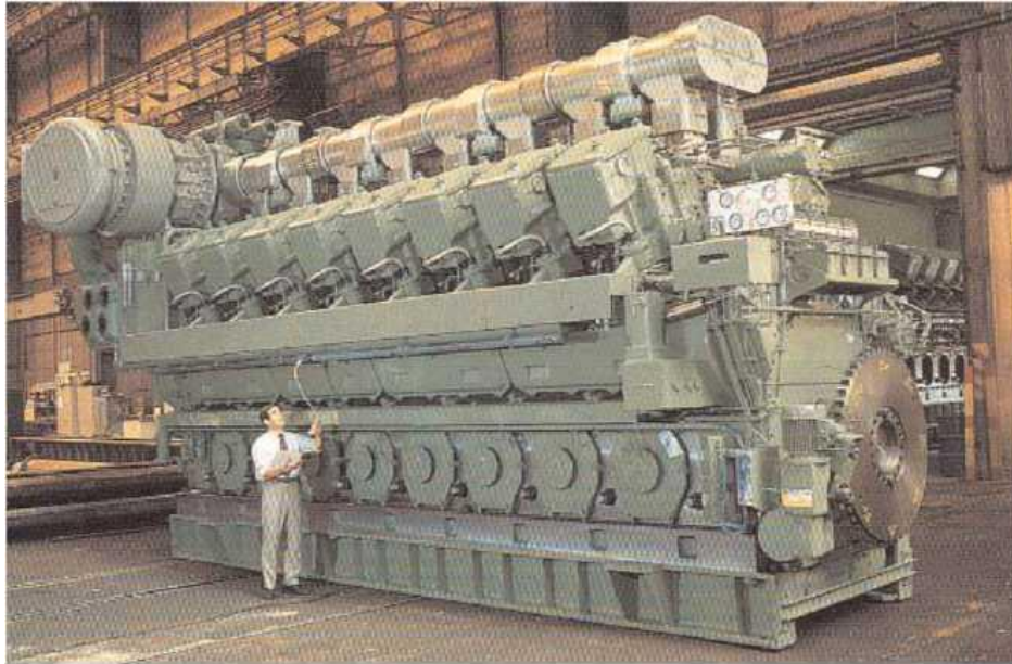
Εικόνα 9: Δεκαεξακύλινδρη μεσόστροφη τετράχρονη πετρελαιομηχανή, ισχύος 11.520 kW (πηγή: διαδίκτυο)
