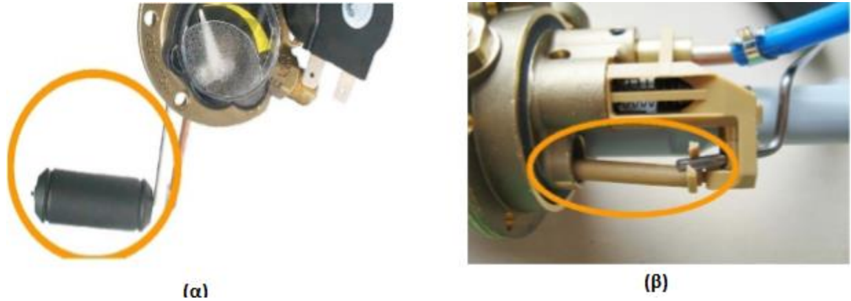
Σχήμα 24 Διάταξη της βαλβίδας διακοπής 80%
