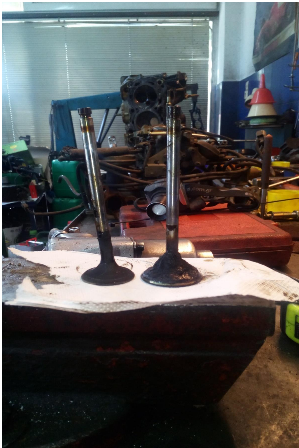
Εικόνα 44 : Μία «καρφωμένη» βαλβίδα και μια κανονική ( Πηγή : Συνεργείο αυτοκίνητων Γιαννακάκης Αθανάσιος )
