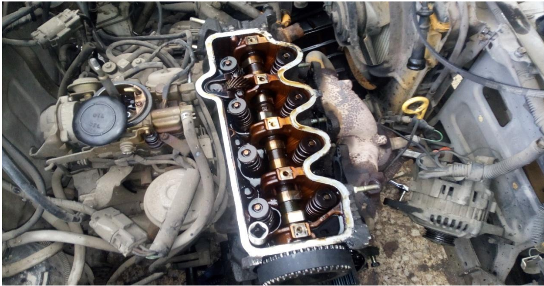
Εικόνα 32: Η ΜΕΚ μετά το χρονισμό με καινούργιο ιμάντα ( Πηγή : Συνεργείο αυτοκίνητων Γιαννακάκης Αθανάσιος )
