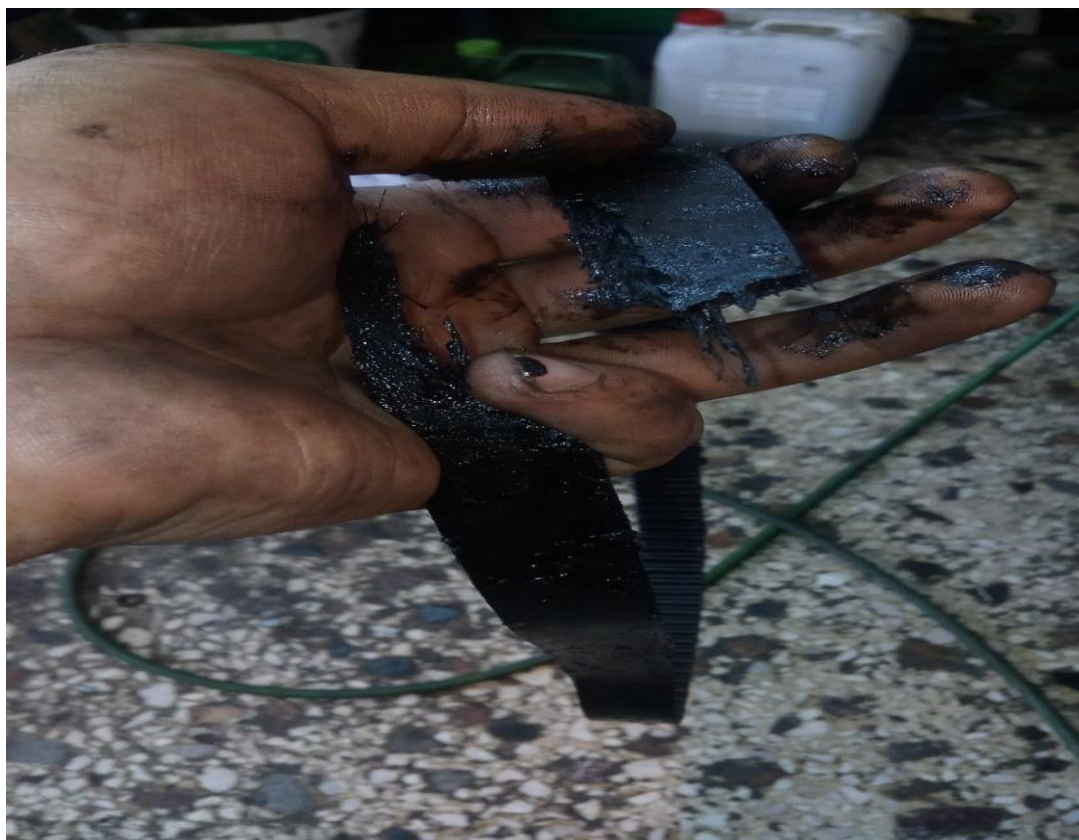
Εικόνα 31 : Κομμένος ιμάντας χρονισμού ( Πηγή : Συνεργείο αυτοκίνητων Γιαννακάκης Αθανάσιος )
