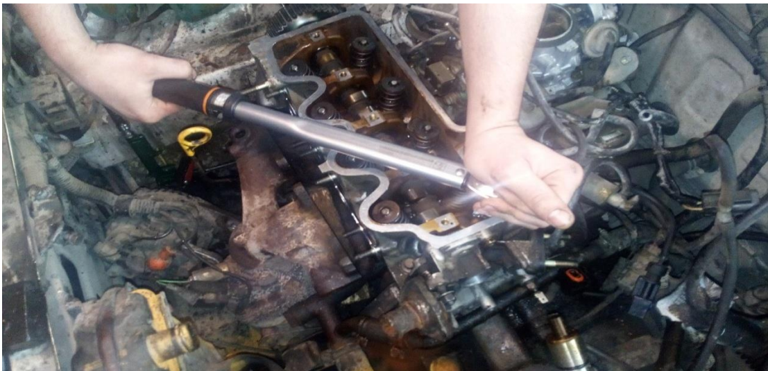
Εικόνα 76 : Σύσφιξη κυλινδροκεφαλής ( Πηγή : Συνεργείο αυτοκίνητων Γιαννακάκης Αθανάσιος )
