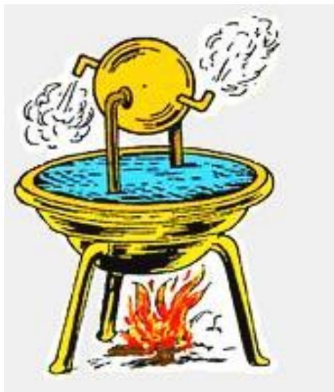
Σχήμα 3: Σχηματική απεικόνιση της Σφαίρας του Ήρωνος [2]
