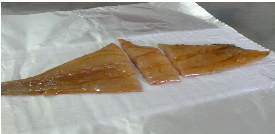
Εικόνα 3.3.1 Τεμαχισμός φιλέτου σε τρία μέρη για χημικές αναλύσεις, γευστικές δοκιμές και μέτρηση ενόργανης σκληρότητας.
