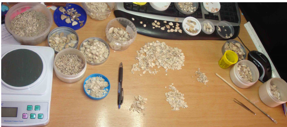
Εικόνα 4. Διαχωρισμός των υλικών των δειγμάτων και ζύγισμα ανά κατηγορία
