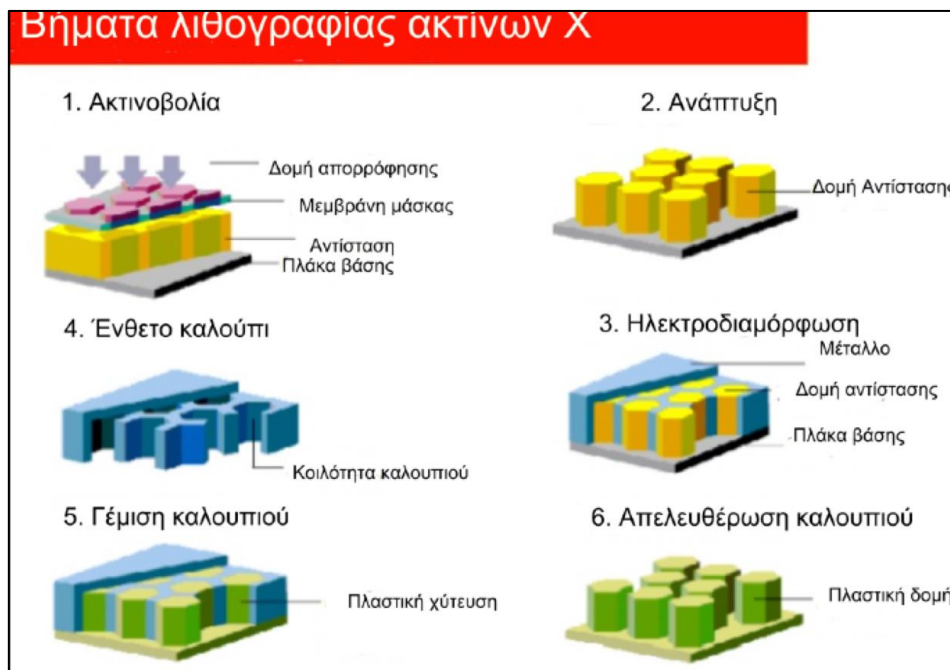
Εικόνα 0.5: Βήματα λιθογραφίας με ακτίνες X [25].
