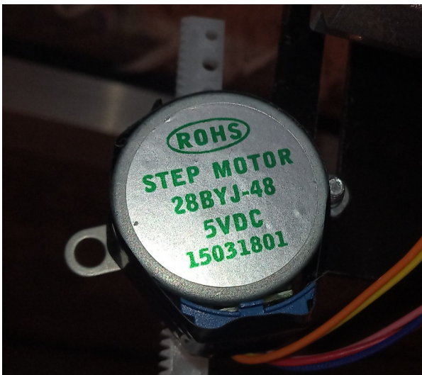
Εικόνα 30: Ο βηματικός κινητήρας στον άξονα Y
