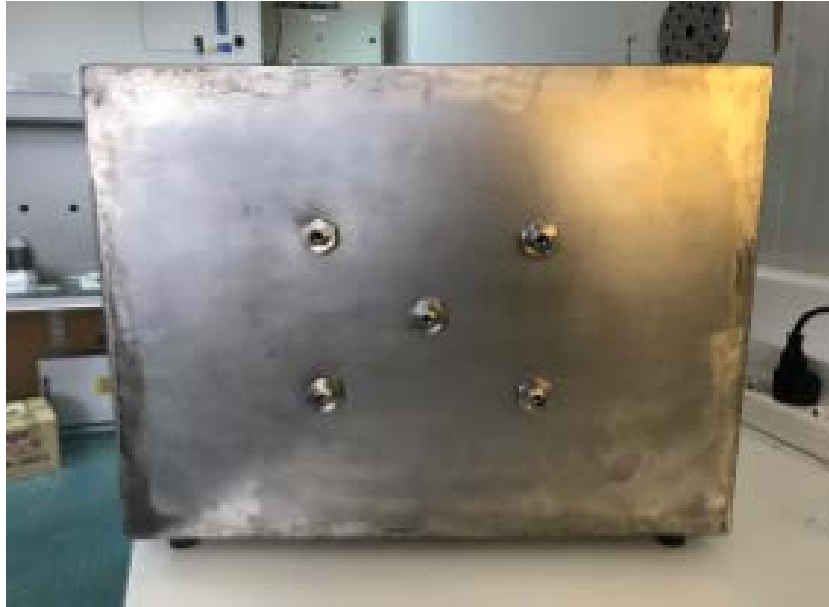
Εικόνα 1.1.1: Εμπρός όψη θαλάμου, οπές εισαγωγής ρευστού.
