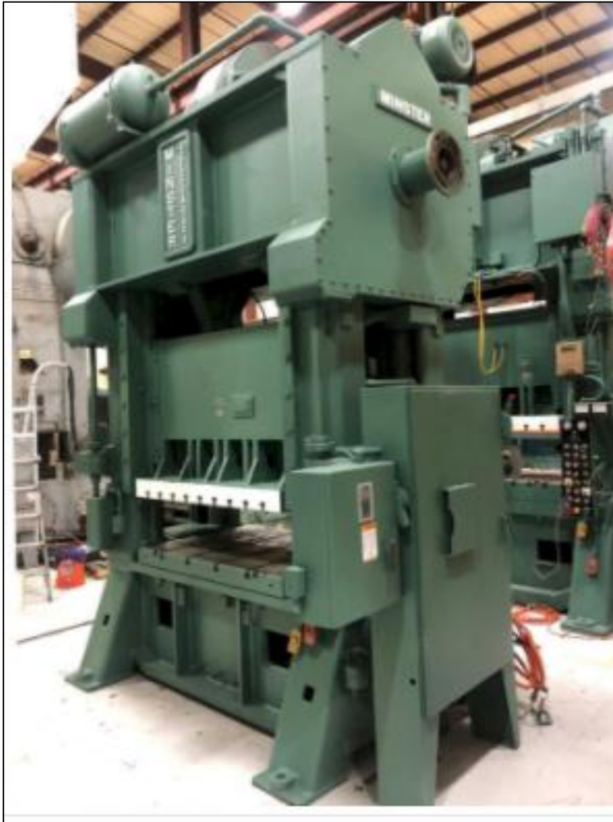
Σχ. 1.16 Πρέσα ευθείας πλευράς 200 τόνων MINSTER SC2-200-60-42 [9]
