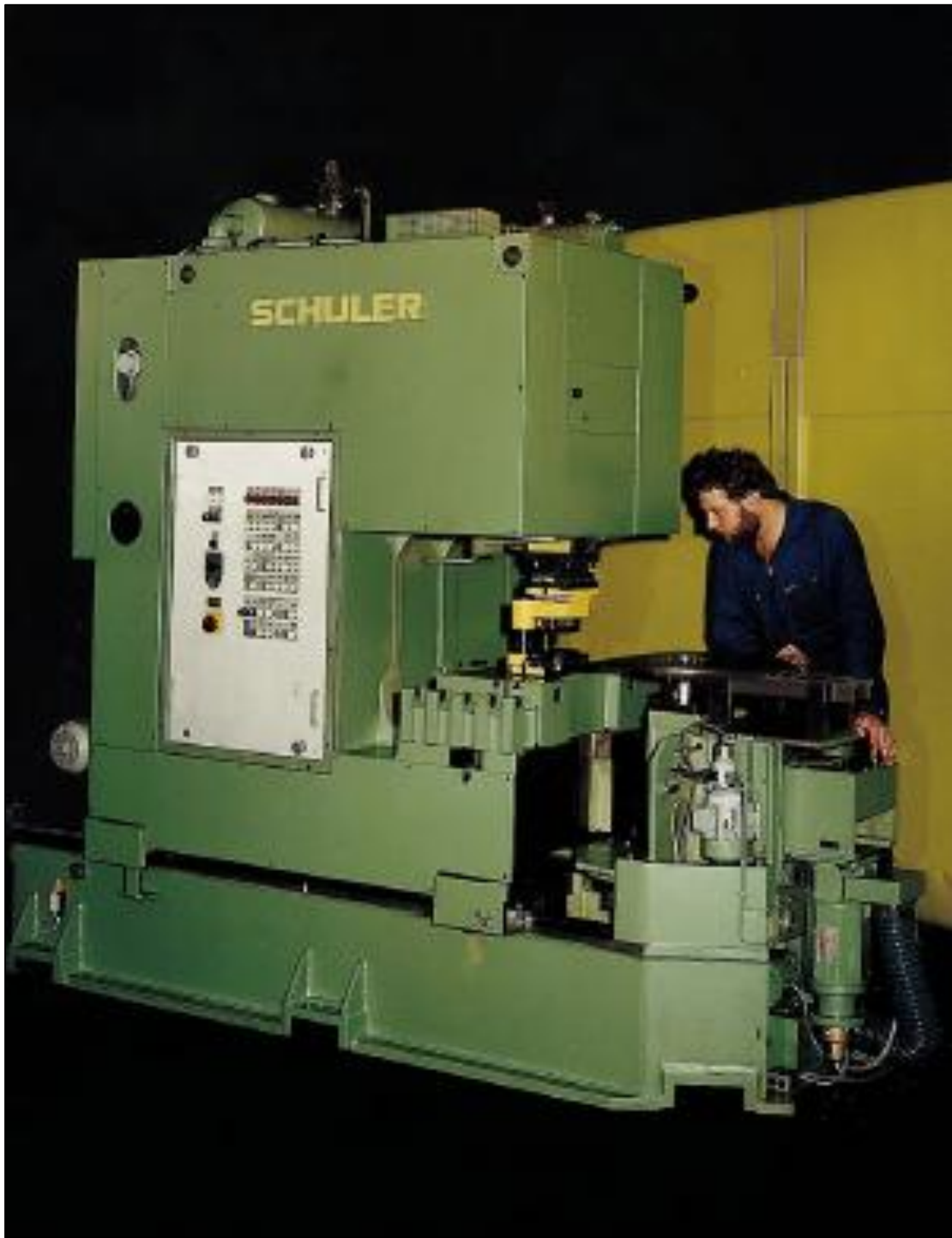
Σχ. 1.14 Μηχανή εγκοπής για κυκλικά καλούπια (ονομαστική δύναμη πίεσης 250 kN) [8]
