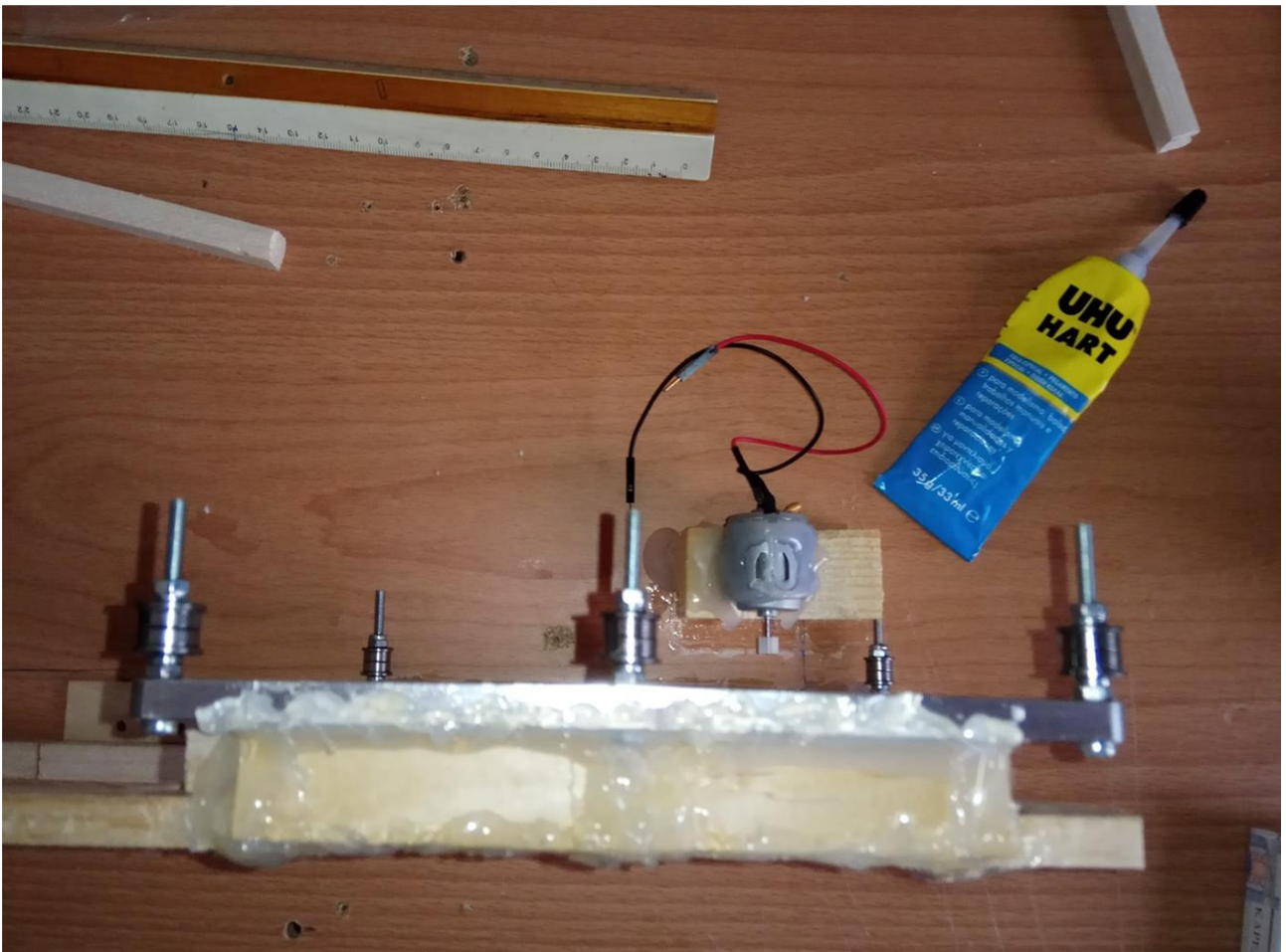
Εικόνα 30: Οδηγοί πόρτας γκαράζ μακέτας με ηλεκτροκινητήρα
