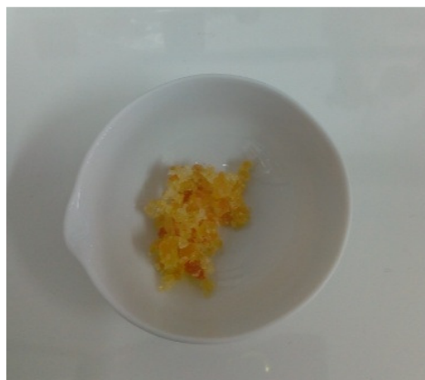
Εικόνα 7: Το υδροπήκτωμα P(DMAM-co-APTACx) που χρησιμοποιήθηκε για τις μετρήσεις προσρόφησης νιτρικών ιόντων \text{NO}_3^- (πριν την προσρόφηση)
