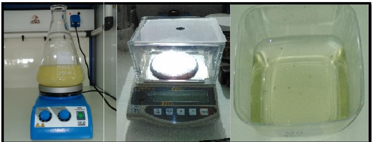
Σχήμα19. Απεικόνιση στο αριστερό τμήμα της κωνικής φιάλη Erlenmeyer με αλατόνερο με τον μαγνητικός αναδευτήρα, για τις ανάγκες ομογενοποίησης του διαλύματος (αλατόνερο), στο κεντρικό τμήμα ο ζυγός ακριβείας για ανάγκες υπολογισμού ποσότητας άλατος και στο δεξιό τμήμα το πειραματικό δοχείο για τις πειραματικές δοκιμασίες αντοχής στην αλατότητα.
