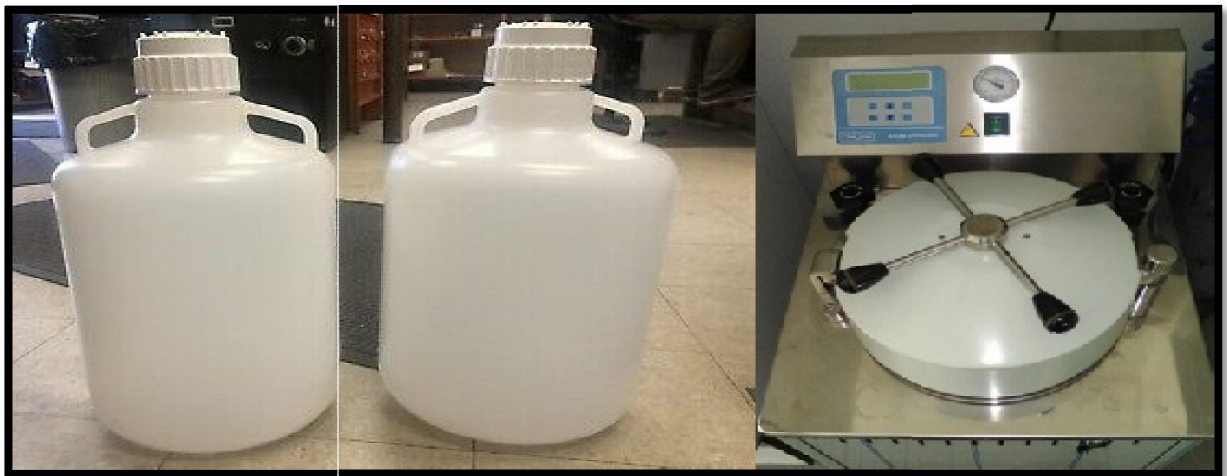
Σχήμα 18. Απεικόνιση, στο αριστερά τμήμα των δοχείων Nalgene 12 λίτρων και στο δεξιό τμήμα το αυτόκαυστο μηχάνημα.
