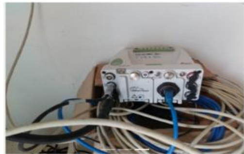
Εικόνα 52: Ο εξοπλισμός του σταθμού του NOANET στην Θήρα (Πηγή: http://geodesy.gein.noa.gr:8000/nginfo/thir/ , Πρόσβαση: 30 Μαρτίου, 2020).
