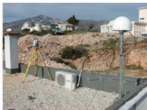
Εικόνα 38: Ο εξοπλισμός του σταθμού του NOANET στην περιοχή της Αττικής (Πηγή: http://geodesy.gein.noa.gr:8000/nginfo/noa1/ , Πρόσβαση: 29 Μαρτίου, 2020).
