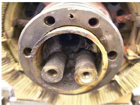
Σχήμα 6.6 Αποτυχία μόνωσης μολύβδου περιέλιξης ρότορα από ενδιάμεσες εκκενώσεις.
