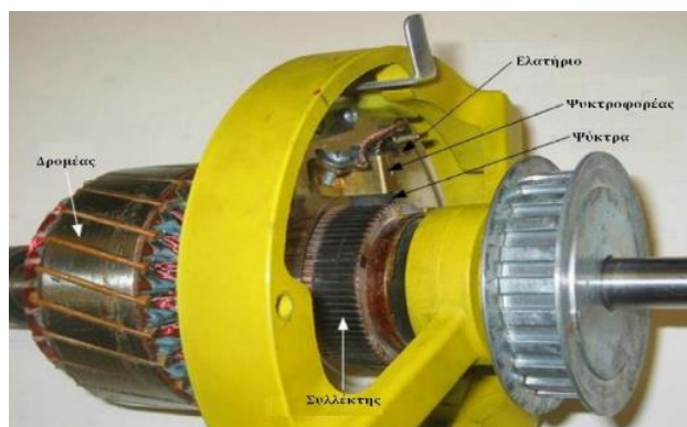
Σχήμα 1.4 : Λεπτομέρεια του ψηκτροφορέα και των ψηκτρών μιας μηχανής συνεχούς ρεύματος.
