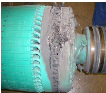
Σχήμα 6.5 Αποτυχία μόνωσης σπειρών περιέλιξης δρομέα από μερικές εκκενώσεις.
