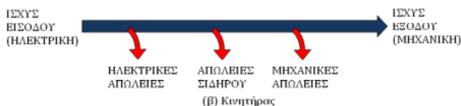
Σχήμα 1.7 : Διάγραμμα ροής ισχύος κινητήρα συνεχούς ρεύματος .
