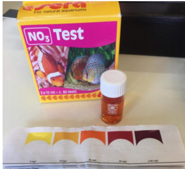
Εικόνα 8. Χρωματομετρική μέτρηση των νιτρικών ιόντων (Πηγή: προσωπικό αρχείο συγγραφέων).
