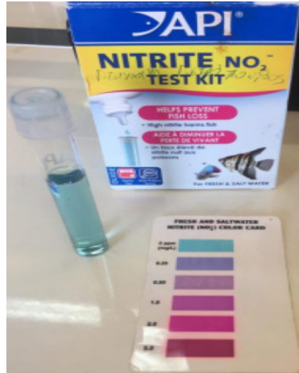
Εικόνα 7. Χρωματομετρική μέτρηση των νιτρωδών ιόντων (Πηγή: προσωπικό αρχείο συγγραφέων).
