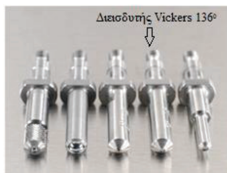
Εικόνα 8.19: Αδαμάντινος διεισδυτής Vickers 136^{\circ}
