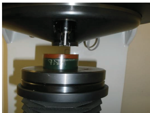
Εικόνα 8.15: Διαδικασία εφαρμογής φορτίου κατά Vickers
