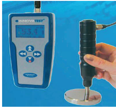
Εικόνα 3.3: Φορητό σκληρόμετρο που βασίζεται στη μέθοδο σκληρομέτρησης με υπερήχους (Μέθοδος UCI).
