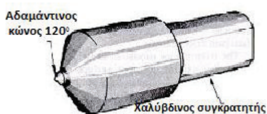
Εικόνα 2: Δεισδυτής αδαμάντινου κώνου 120^{\circ} Rockwell
