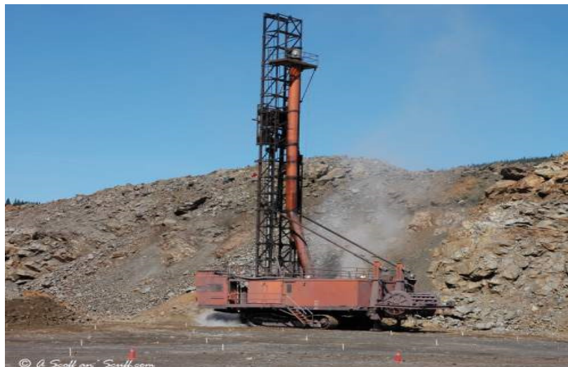
Εικόνα 26. Γεωτρήση ειδικού σκοπού για διαπερατότητα πετρωμάτων
