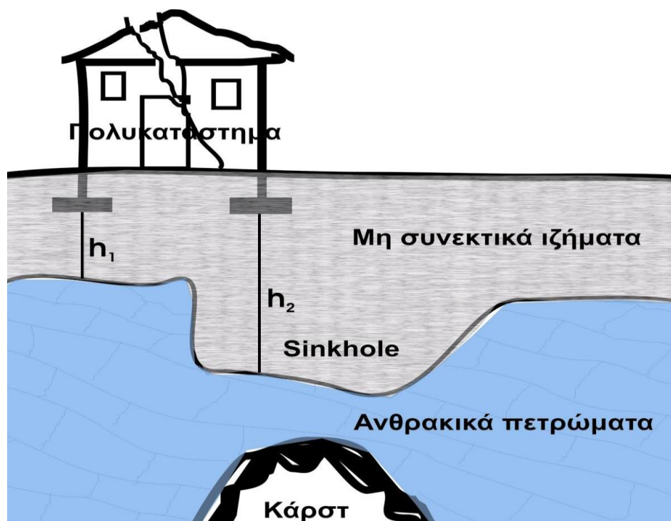
Εικόνα 2.41 - Κακή επιλογή χώρου θεμελίωσης σε θέση με γρήγορη μεταβολή του μεγέθους της εδαφικής υποχώρησης.
