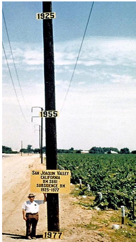
Εικόνα 2.5 - Υποχώρηση εδάφους στην κοιλάδα του San Joaquin στην California.
