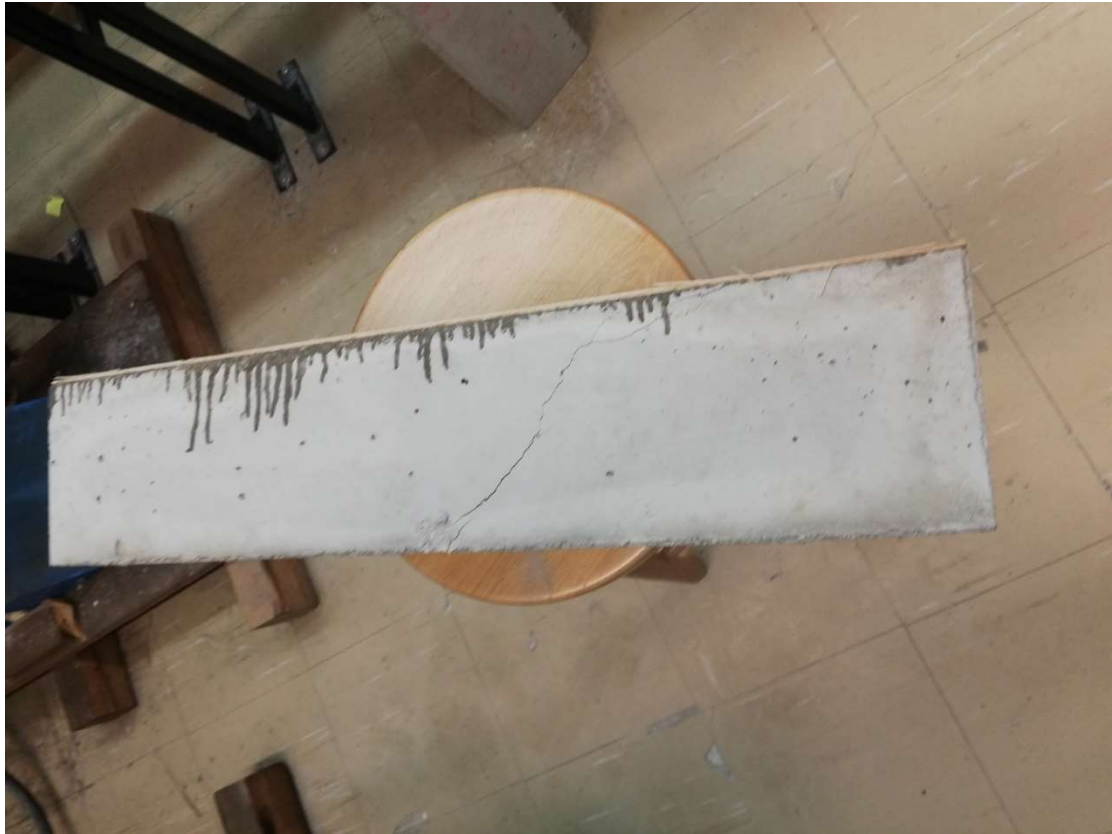
Εικόνα 53. Ρωγμές αστοχίας δοκιμίου 3 μετά την δοκιμή της κάμψης.
