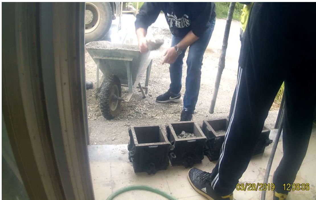
Εικόνα 29β. Σκυροδέτηση τετραγωνικών καλουπιών
