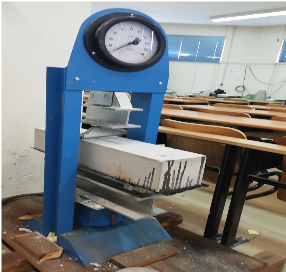
Εικόνα 48. Δοκίμιο σκυροδέματος ενισχυμένο με φύλλο FRP κατά την δοκιμή της κάμψης
