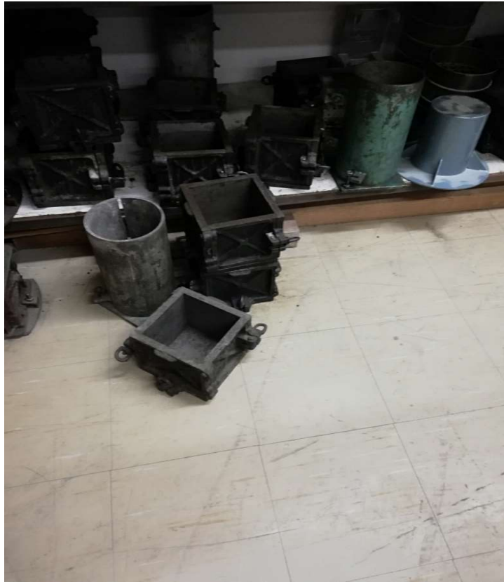
Εικόνα 18. Μήτρες κυβικών δοκιμίων
