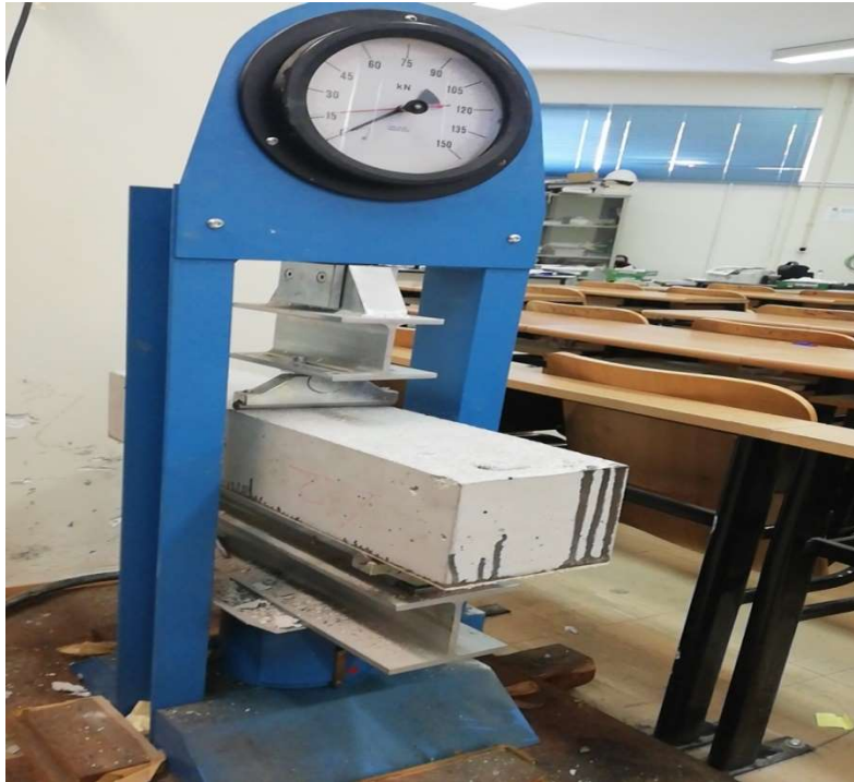
Εικόνα 51. Δοκίμιο σκυροδέματος ενισχυμένο με φύλλο ξύλου κατά την δοκιμή της κάμψης
