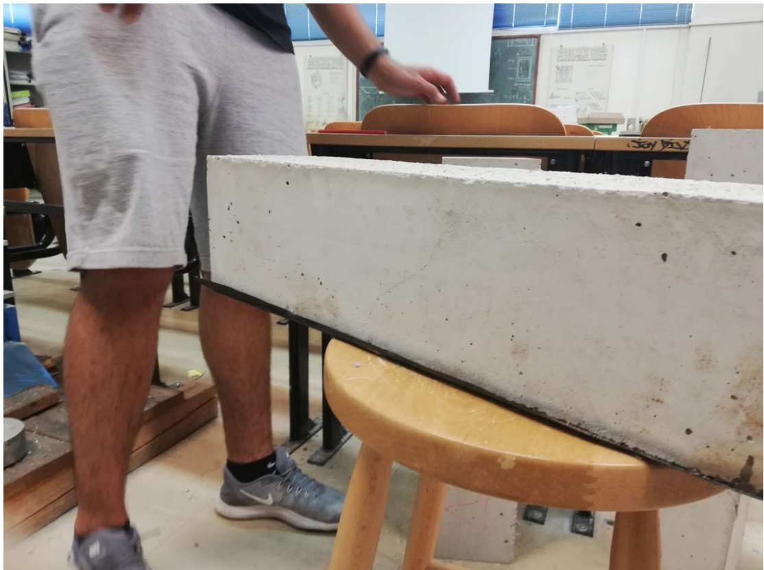
Εικόνα 50. Ρωγμές αστοχίας δοκιμίου 2 μετά την δοκιμή της κάμψης.
