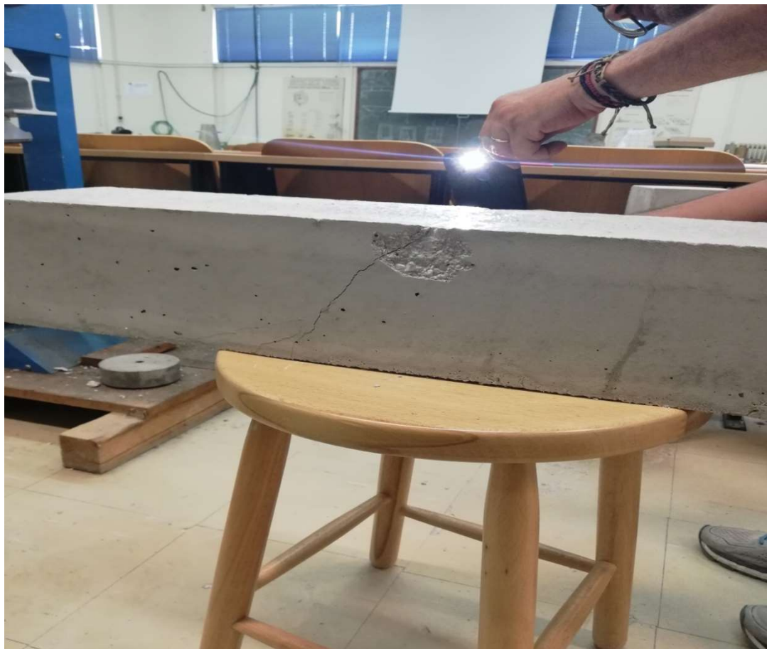
Εικόνα 56. Ρωγμές αστοχίας δοκιμίου 4 μετά την δοκιμή της κάμψης.
