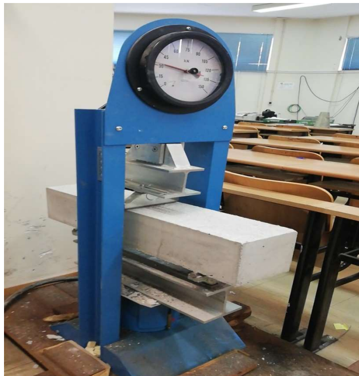
Εικόνα 54. Δοκίμιο σκυροδέματος χωρίς ενίσχυση κατά την δοκιμή της κάμψης
