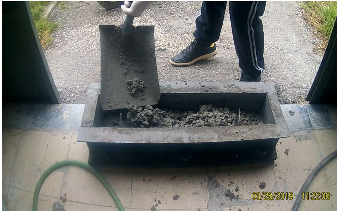
Εικόνα 25. Πλήρωση ορθογωνικών καλουπιών (δεύτερη στρώση)
