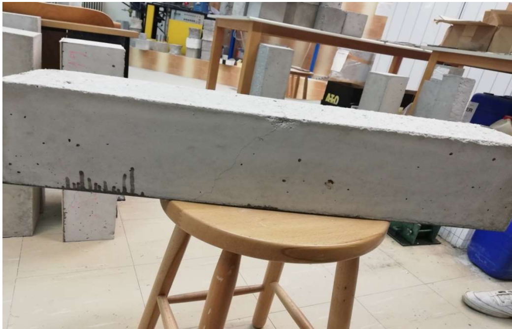
Εικόνα 58. Ρωγμές αστοχίας δοκιμίου 5 μετά την δοκιμή της κάμψης.
