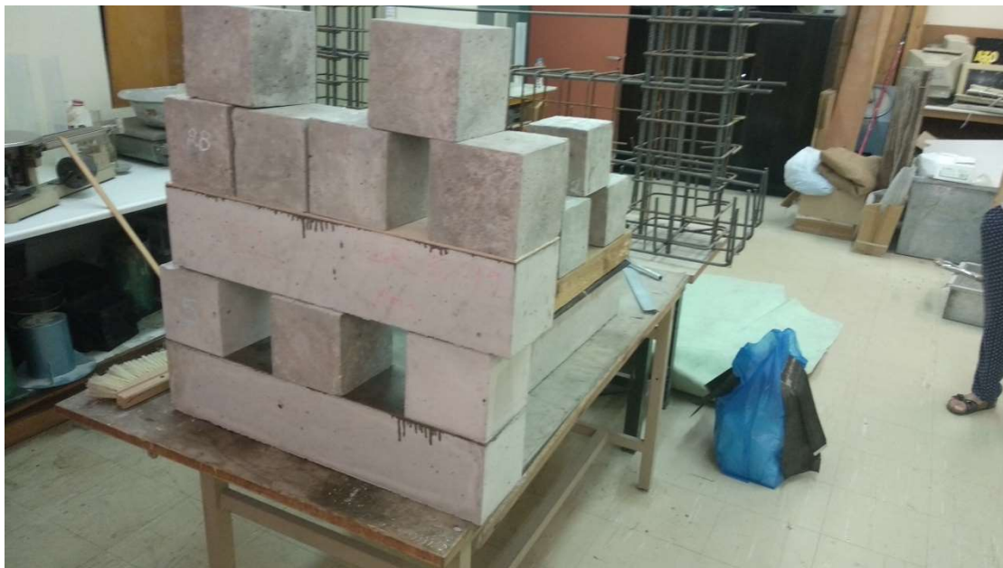
Εικόνα 42. Δοκίμια σκυροδέματος με ενίσχυση
