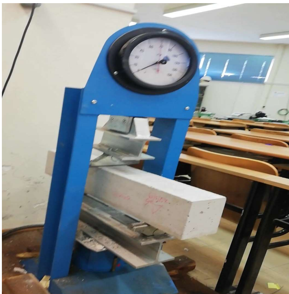
Εικόνα 44. Δοκίμιο σκυροδέματος χωρίς ενίσχυση κατά την δοκιμή της κάμψης
