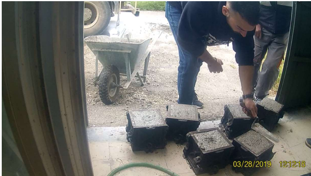
Εικόνα 30. Τελική μορφή σκυροδέτησης
