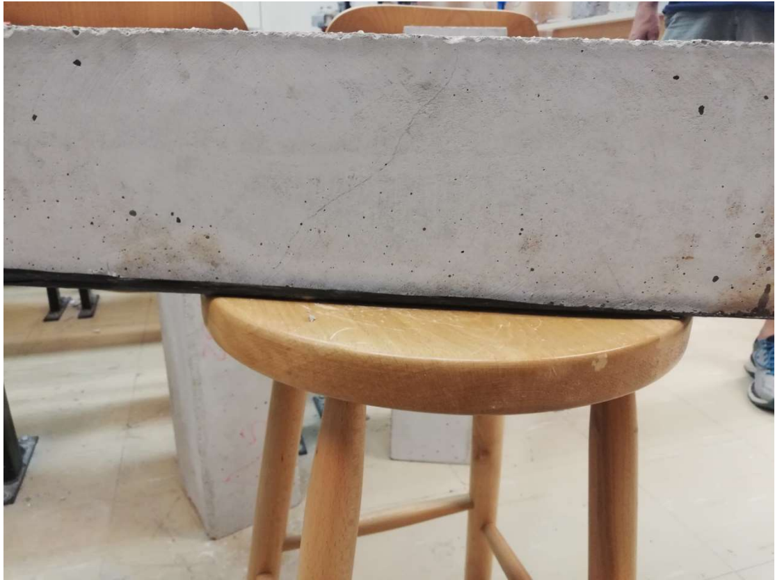
Εικόνα 49. Ρωγμές αστοχίας δοκιμίου 2 μετά την δοκιμή της κάμψης.
