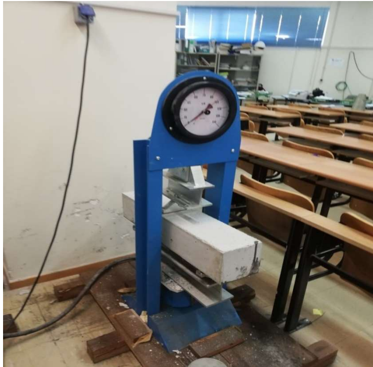
Εικόνα 57. Δοκίμιο σκυροδέματος ενισχυμένο με φύλλο χάλυβα κατά την δοκιμή της κάμψης
