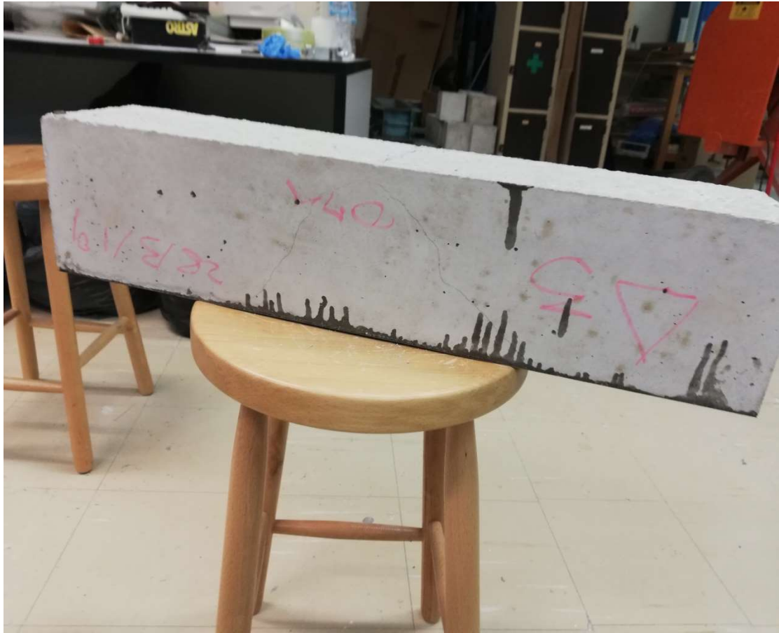
Εικόνα 59. Ρωγμές αστοχίας δοκιμίου 5 μετά την δοκιμή της κάμψης.
