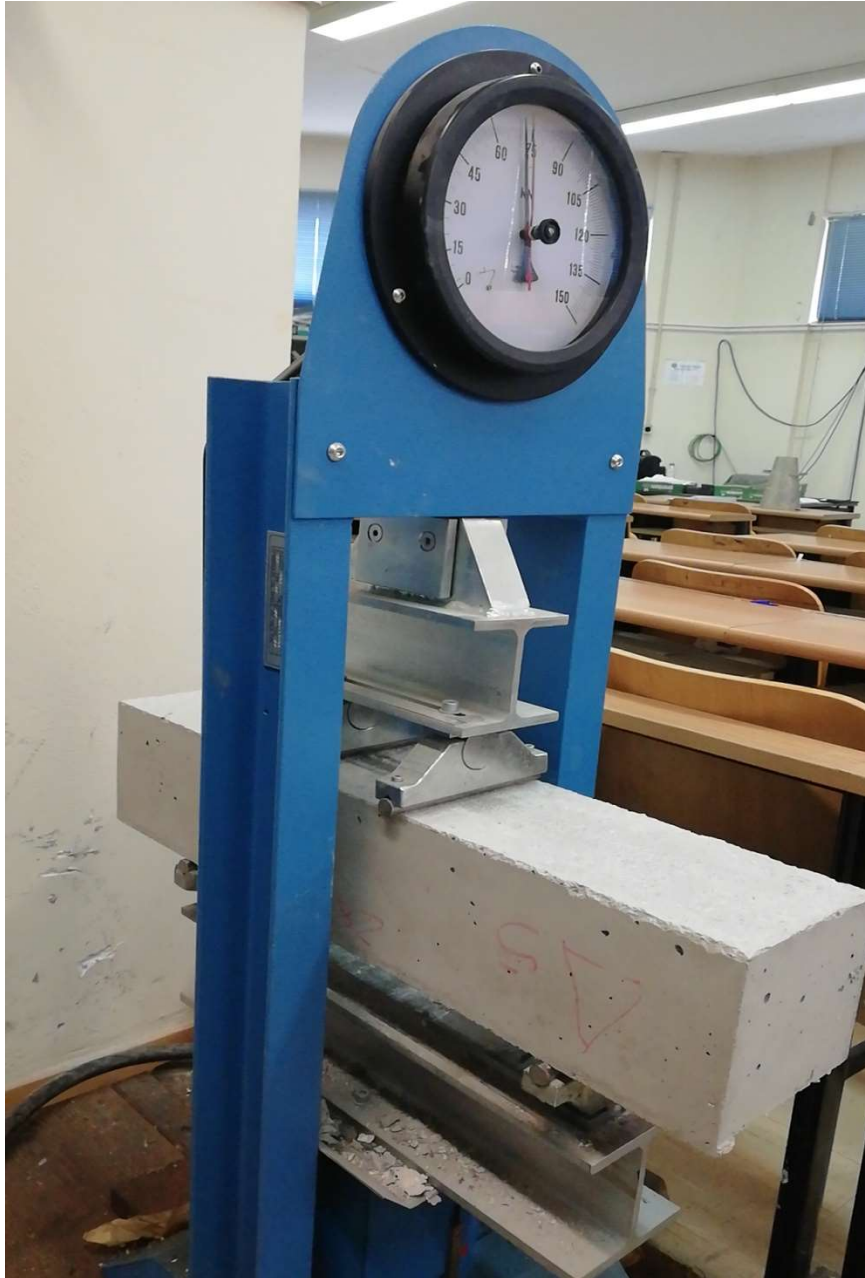
Εικόνα 43. Δοκιμή σε κάμψη ορθογωνικών δειγμάτων
