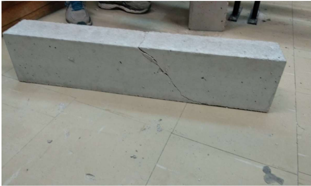
Εικόνα 45. Ρωγμές αστοχίας δοκιμίου 1 μετά την δοκιμή της κάμψης.
