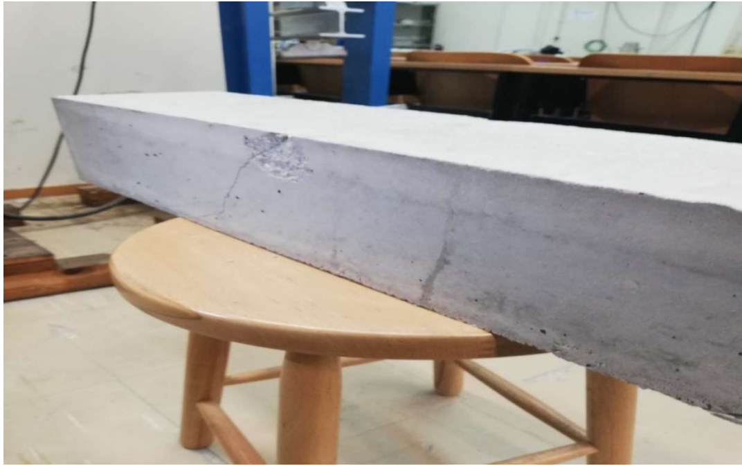
Εικόνα 55. Ρωγμές αστοχίας δοκιμίου 4 μετά την δοκιμή της κάμψης.
