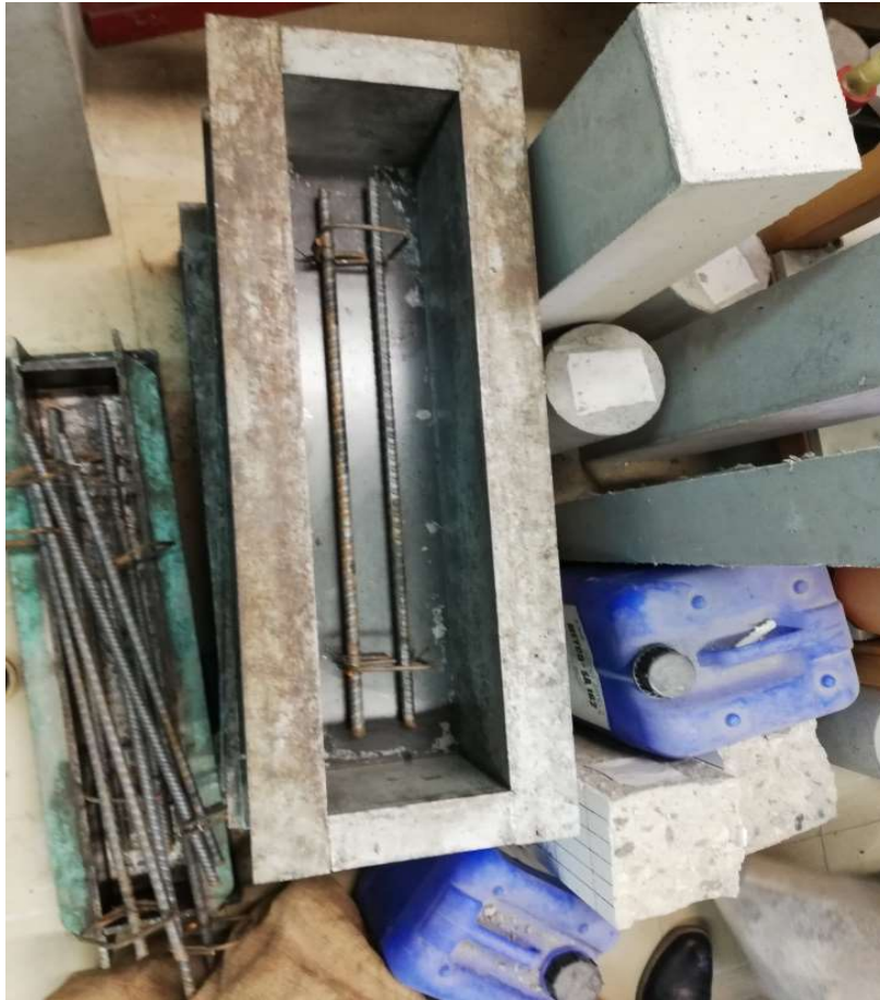
Εικόνα 22. Τοποθέτηση οπλισμού στην ορθογωνική μήτρα
