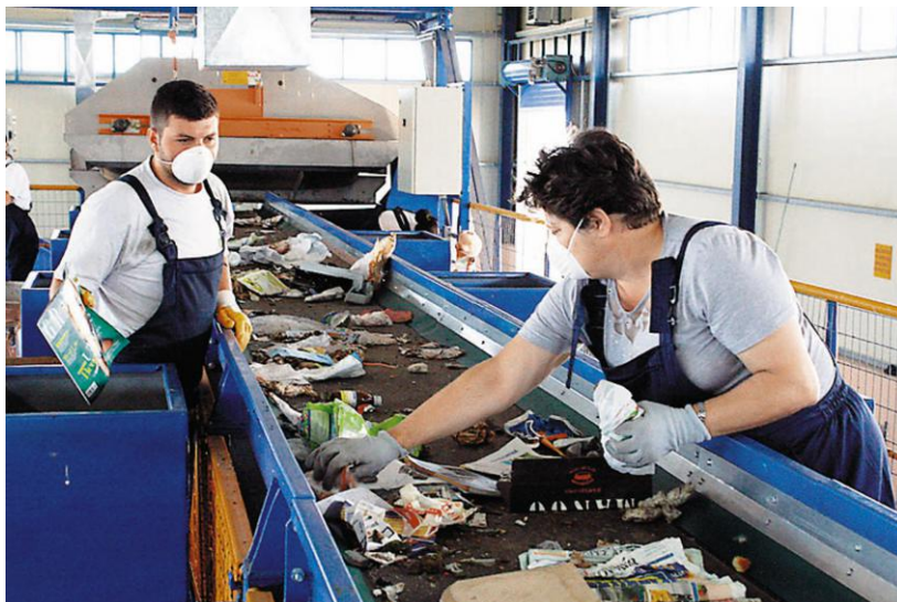
Σχήμα 2.2: Απεικόνιση χειροδιαλογής σε ένα εργοστάσιο επεξεργασίας απορριμμάτων.
