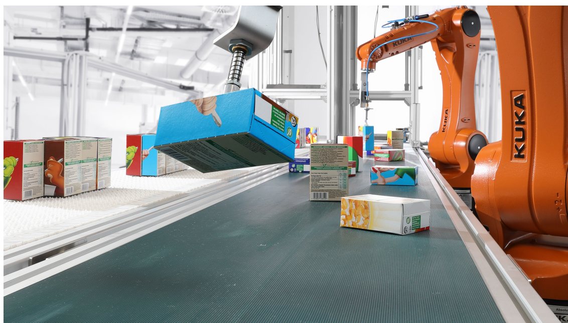
Σχήμα 4.12: Τα KUKA.PickControl και KR AGILUS σε συγχρονισμένη δράση σε εργοστάσιο συσκευασίας.
