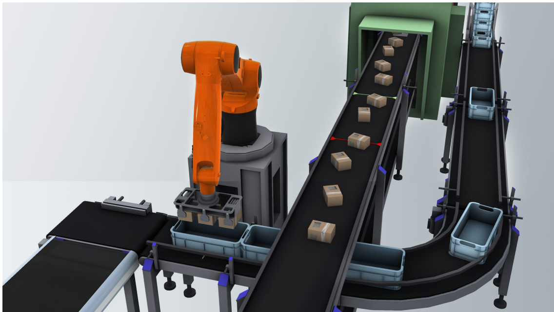
Σχήμα 4.11: Τα KUKA.ConveyorTech και KR AGILUS σε συνεργασία.
