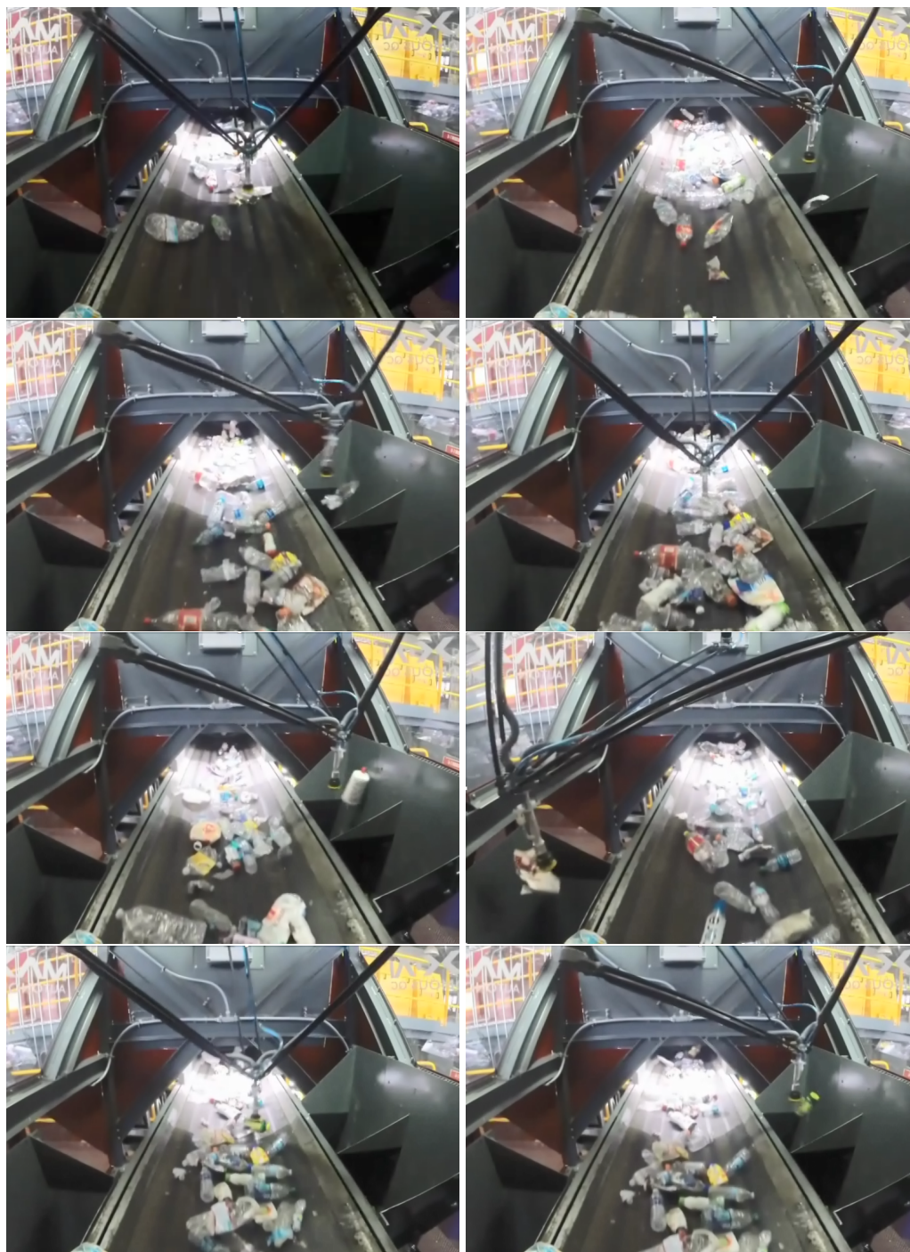
Σχήμα 2.7: Στιγμιότυπα λειτουργίας αυτόνομου ρομποτικού συστήματος διαχωρισμού πλαστικών MAX AI, SDAKO ROBOTICS.
