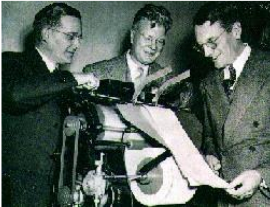
Εικόνα 19: Το Xeroprinter παρουσιάστηκε στα τέλη της δεκαετίας του 1940 από τον John H. Dessauer, τον επικεφαλής της έρευνας του Haloid. Τσέστερ Κάρλσον; και τον Πρόεδρο Haloid Joseph C. Wilson. Αυτή η πρώιμη ξηρογραφική συσκευή, η οποία εκτυπώθηκε σε κυλινδρικό χαρτί, κέντρισε την προσοχή του κοινού, αλλά ποτέ δεν διατέθηκε στο εμπόριο ως προϊόν.
