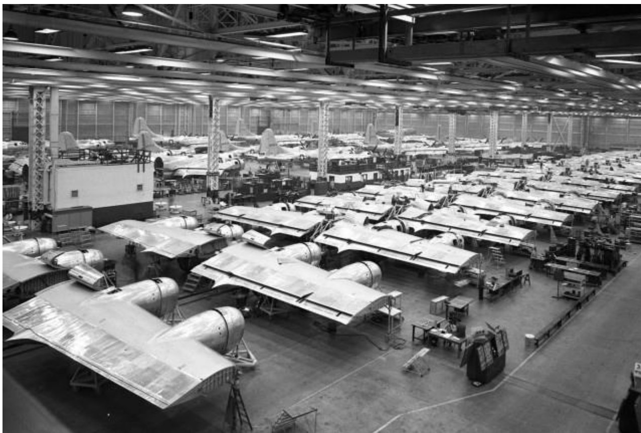
Εικόνα 27: Στο ύψος της παραγωγής, τα B-29 για την Πολεμική Αεροπορία συναρμολογήθηκαν σε 4 γραμμές στο Renton.
