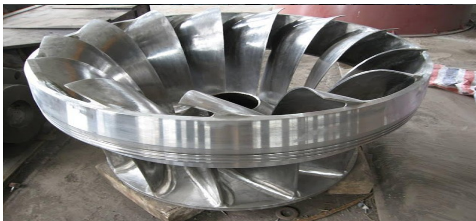
Εικόνα 5.8: Δρομέας υδροστροβίλου Francis (πηγή: Mechanical Engineering)
