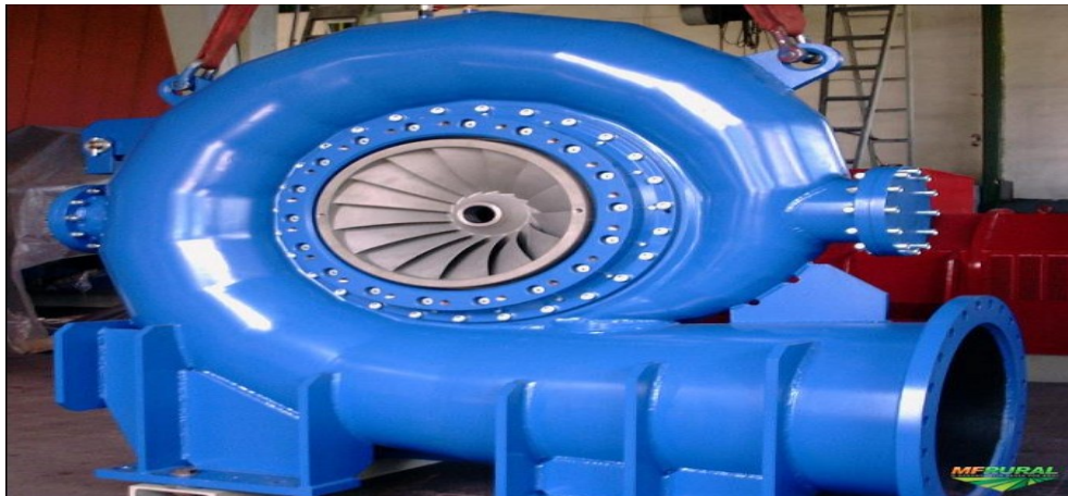
Εικόνα 5.7: Υδροστρόβιλος Francis (πηγή: MF RURAL)
