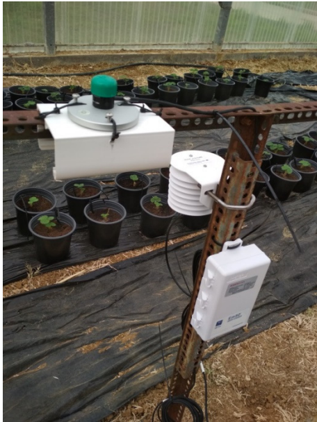
Εικόνα 25: Σύνθετος αισθητήρας θερμοκρασίας αέρα, σχετικής υγρασίας και βαρομετρικής πίεσης μαζί με πυρανόμετρο
