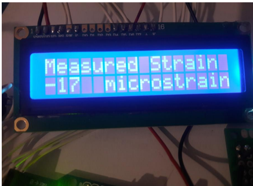
Εικόνα 4.6 : Το σύστημα σε κανονική λειτουργία με αρνητική μέτρηση.
