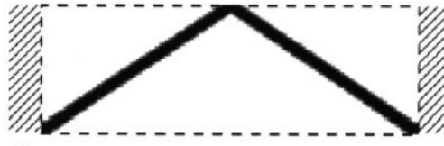
Εικόνα 35. Βελτιστοποίηση με περιορισμό 20% του αρχικού όγκου
