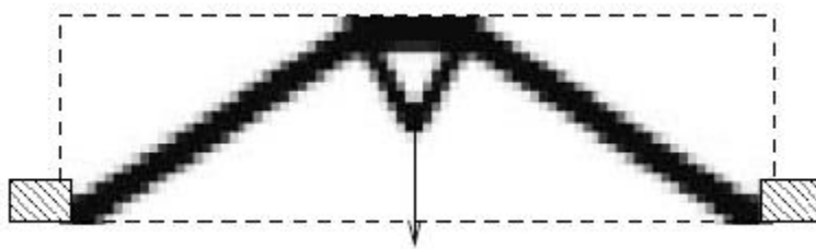
Εικόνα 17. Βελτιστοποίηση με περιορισμό 20% του αρχικού όγκου
