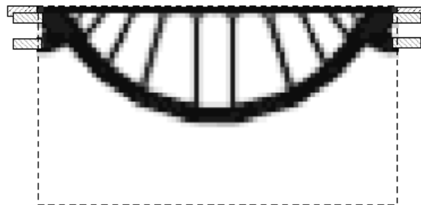
Εικόνα 29. Βελτιστοποίηση με περιορισμό 20% του αρχικού όγκου
