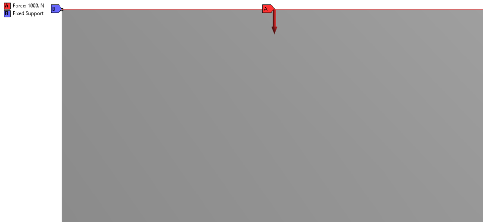
Εικόνα 28. Φορτία και οριακές συνθήκες στο ANSYS
