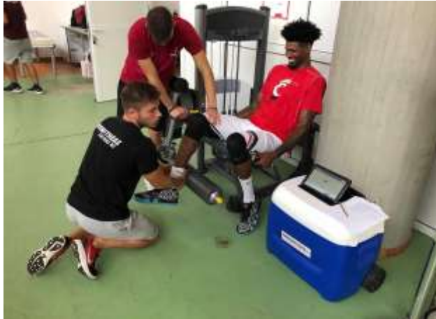
Εικόνα 9. Δυναμομέτρηση με το δυναμόμετρο KFORCE. (προσαρμοσμένο από φωτογραφικό υλικό των εργομετρικών και από https://tendim.be )
