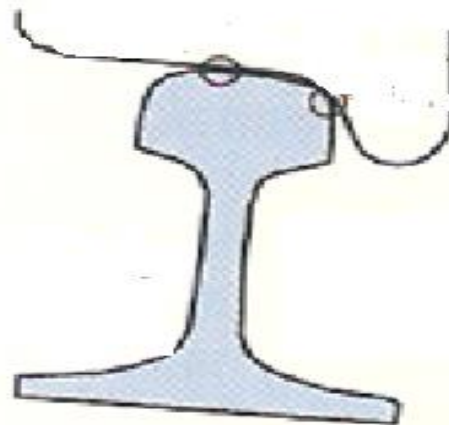
Σχ. 3.7 Διπλή επαφή τροχού - σιδηροτροχιάς
