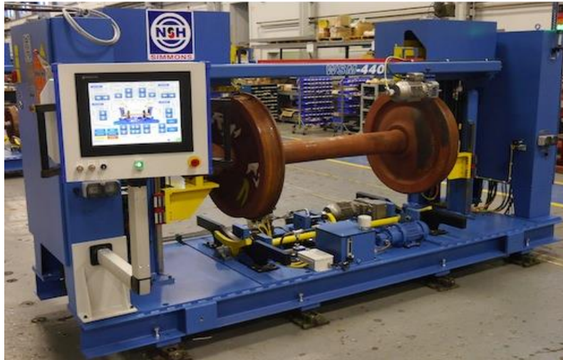
Σχ. 5.14 Τόρνος επισκευής τροχών[20]
