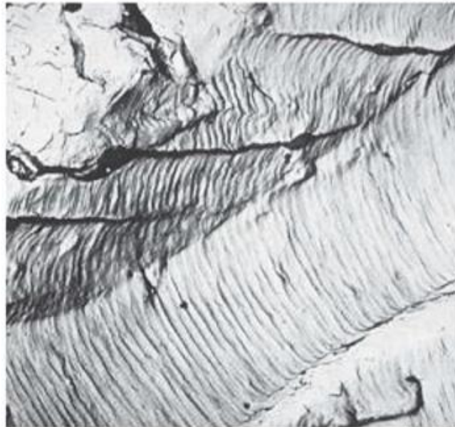
Σχ. 3.24 Επιφάνεια θραύσης με μικρο-ραβδώσεις[9]
