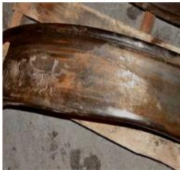
Σχ. 5.3 Πλαστική παραμόρφωση σιδηροδρομικού τροχού[15]
