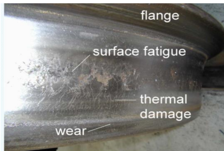
Σχ. 5.6 Φθορά λόγω θερμικής καταπόνησης[15]
