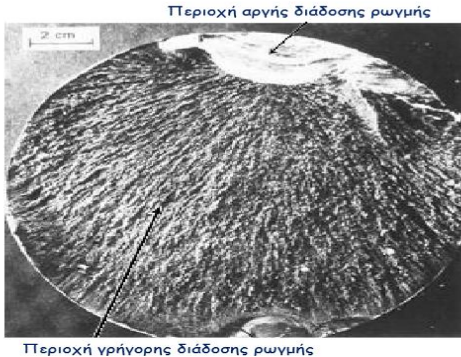
Σχ. 3.25 Γρήγορη αστοχία από κόπωση[9]
