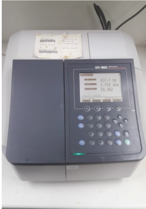
Εικόνα 2.3: Φασματοφωτόμετρο (UV-1800 SHIMADZU SPECTROPHOTOMETER)
