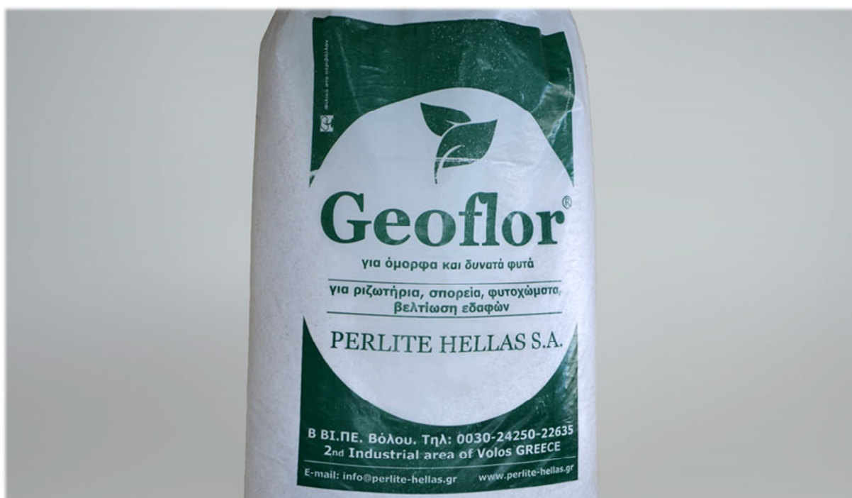
Εικόνα 4.4: Περλίτης Geoflor με κοκκομετρία 0,5-5,0mm.
