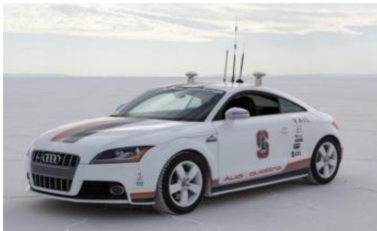
Εικόνα 6. Το Τροποποιημένο Αυτόνομο Αγωνιστικό Όχημα του Πανεπιστημίου Stanford για την μελέτη της Βελτίωσης της Ασφάλειας
